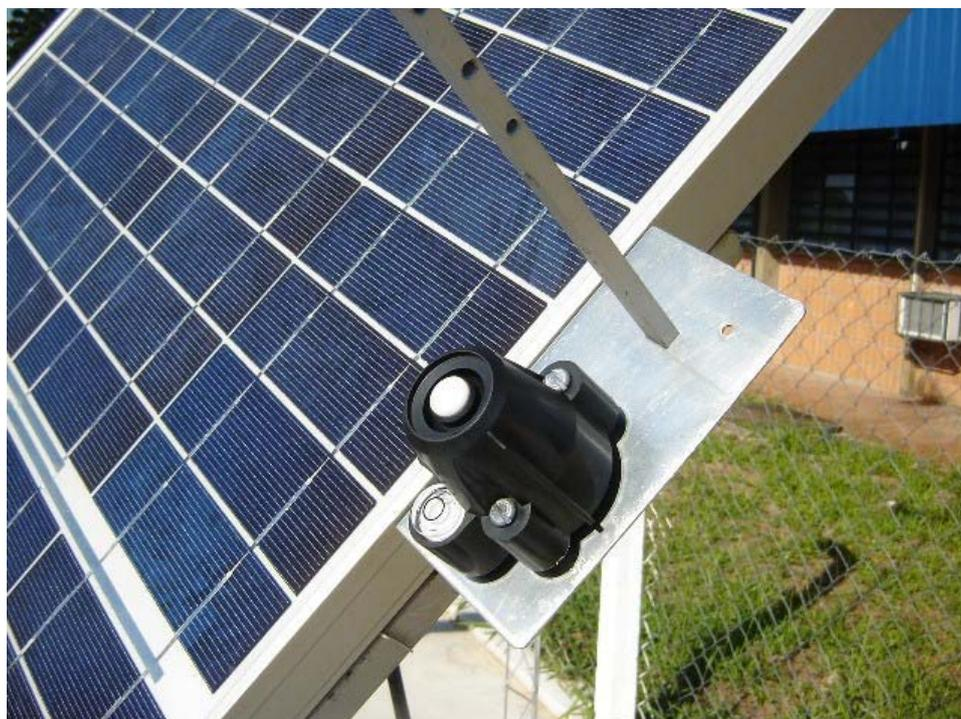
**Figura 62 – Detalhe do sensor de radiação instalado no plano do painel fotovoltaico**
