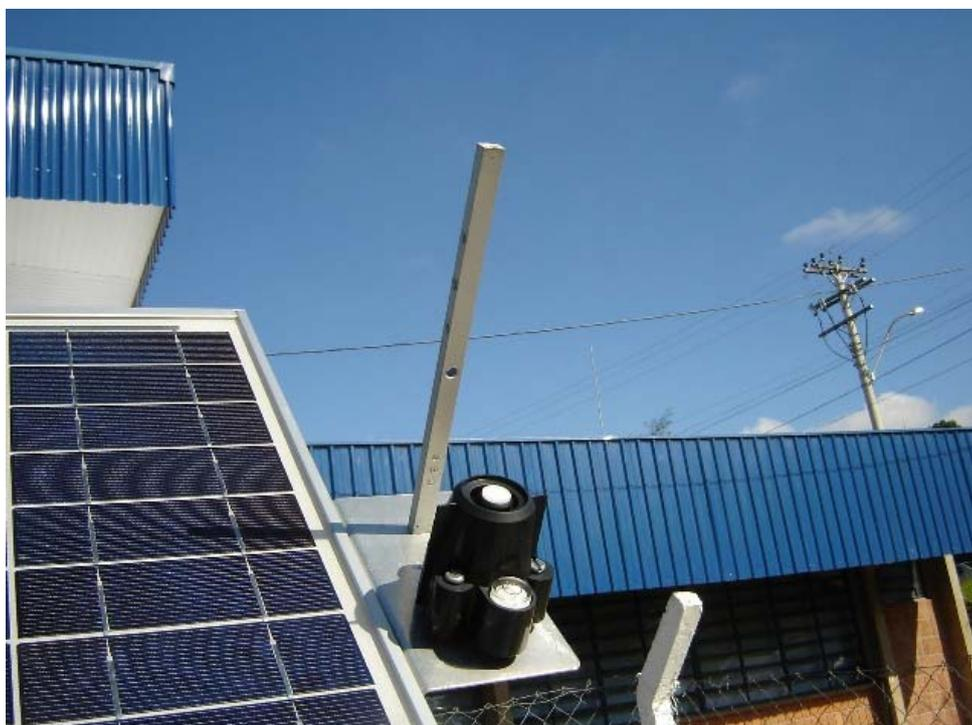
**Figura 64 – Detalhe da vareta indicadora do correto posicionamento**
