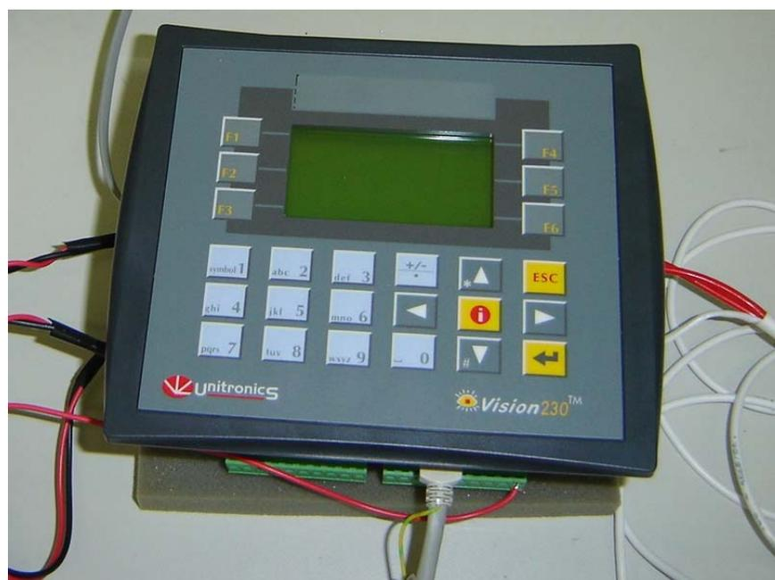
**Figura 46 – Aspecto externo da CPU Vision 230 da Unitronics**
