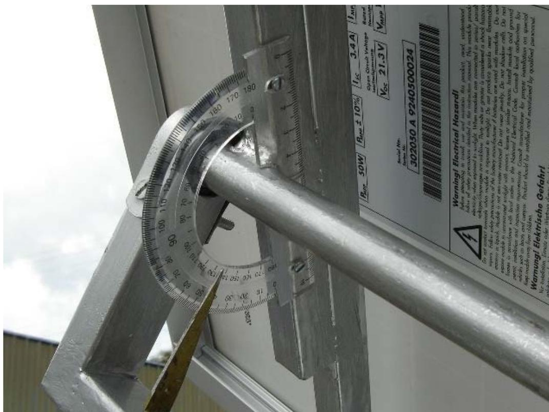
Figura 65 – Transferidor para calibração do Ângulo Horário
