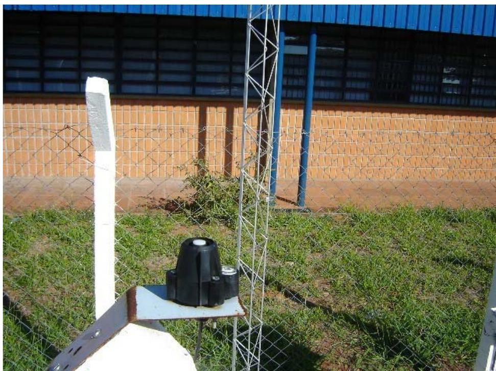
**Figura 63 – Detalhe do sensor de radiação instalado em plano horizontal**
