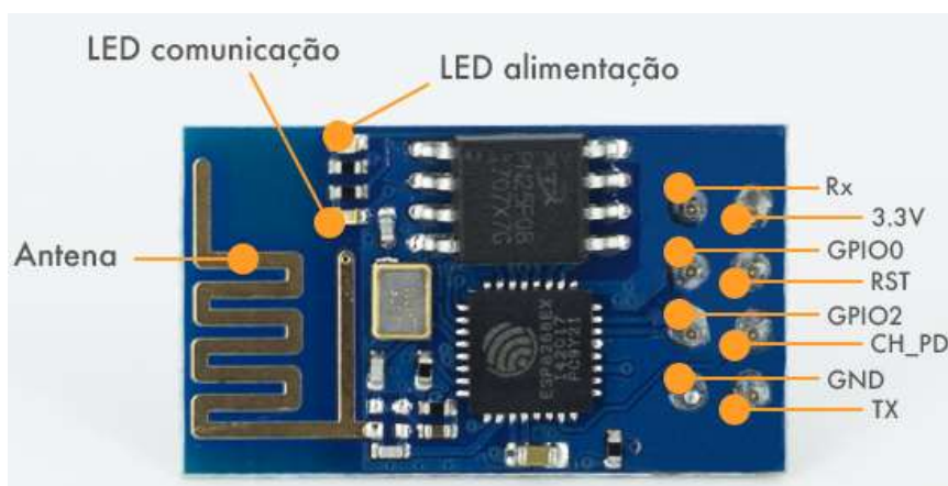
Figura 14 – Identificando o ESP8266 ESP-01
