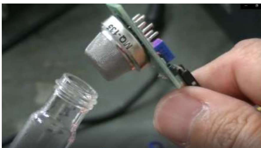
Figura 54 – Teste do sensor MQ-135
