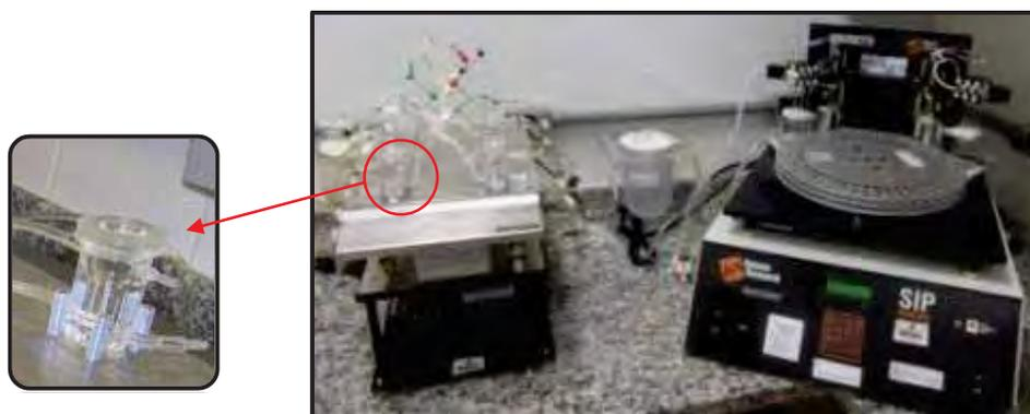
**Figura 5:** Fotografia do sistema de difusão do tipo Franz formado por seis células
