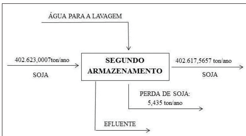
Figura 23 – Esquema de entradas e saídas no segundo armazenamento.
