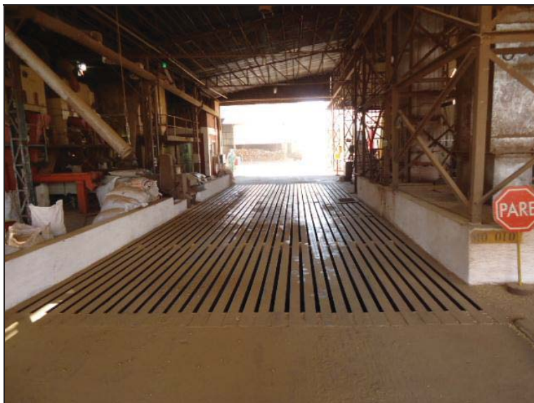
Figura 10 – Entrada da matéria-prima no processo produtivo por meio das moegas.
