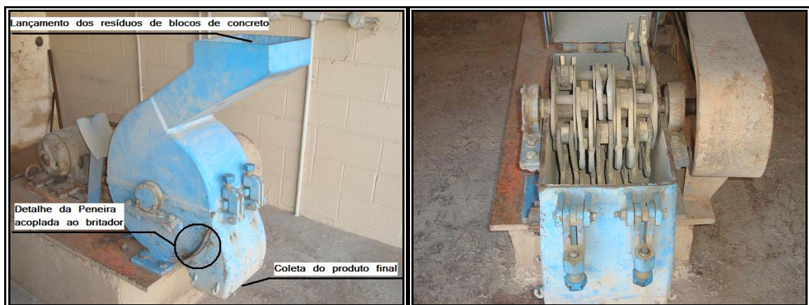
Figura 21: Britador de facas utilizado na preparação do agregado miúdo artificial.
