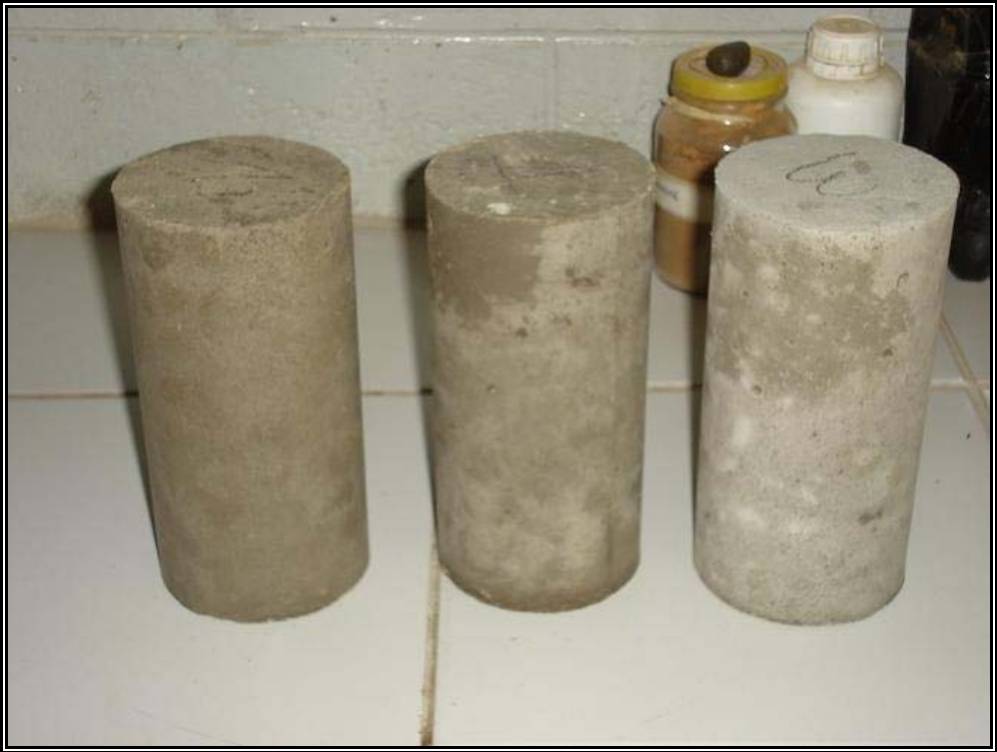
Figura 24: Aparência dos corpos-de-prova referentes aos traços 1:8, 1:6 e 1:4 posicionados nesta ordem da esquerda para a direita.
