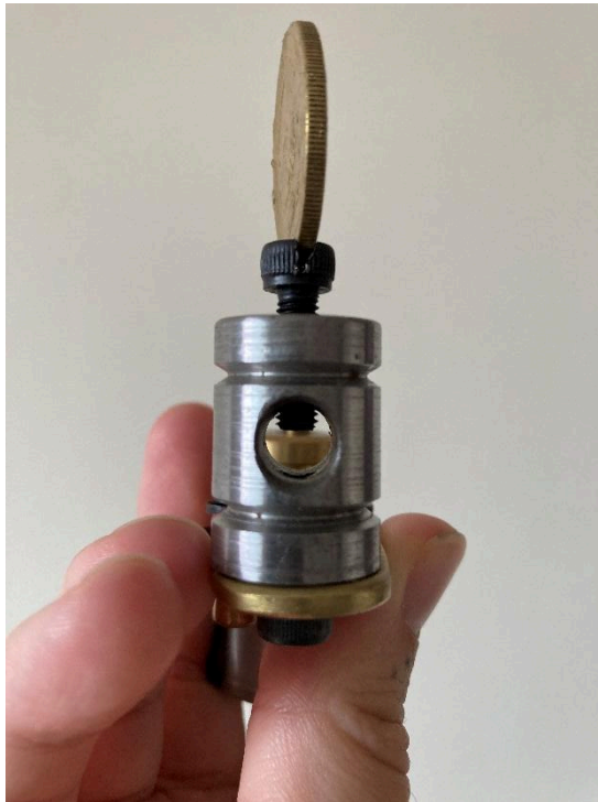
Figura 13 – Detalhe inferior do aperto de biqueira
