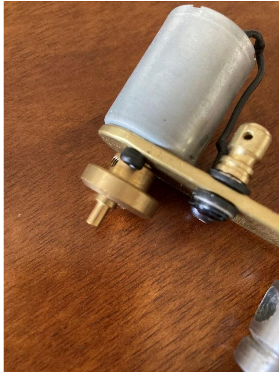
Figura 9 – Detalhe lateral do rolamento de curso
