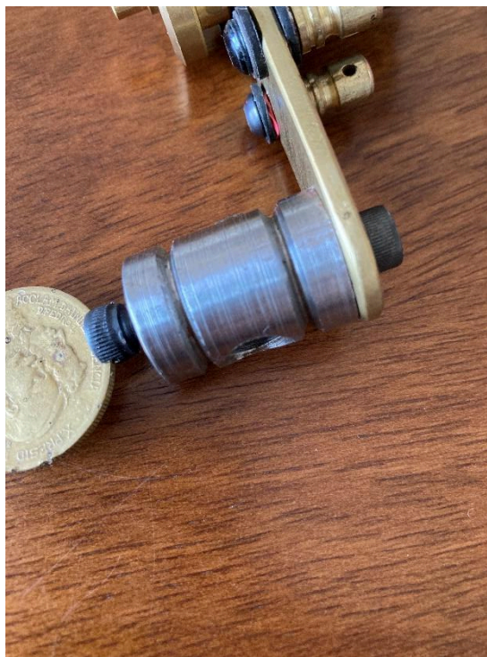
Figura 12 – Detalhe lateral do aperto de biqueira
