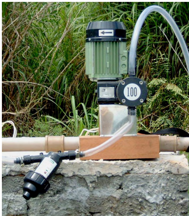
Figura 3 Bomba elétrica Multifertic MF-100 utilizada durante o experimento.
