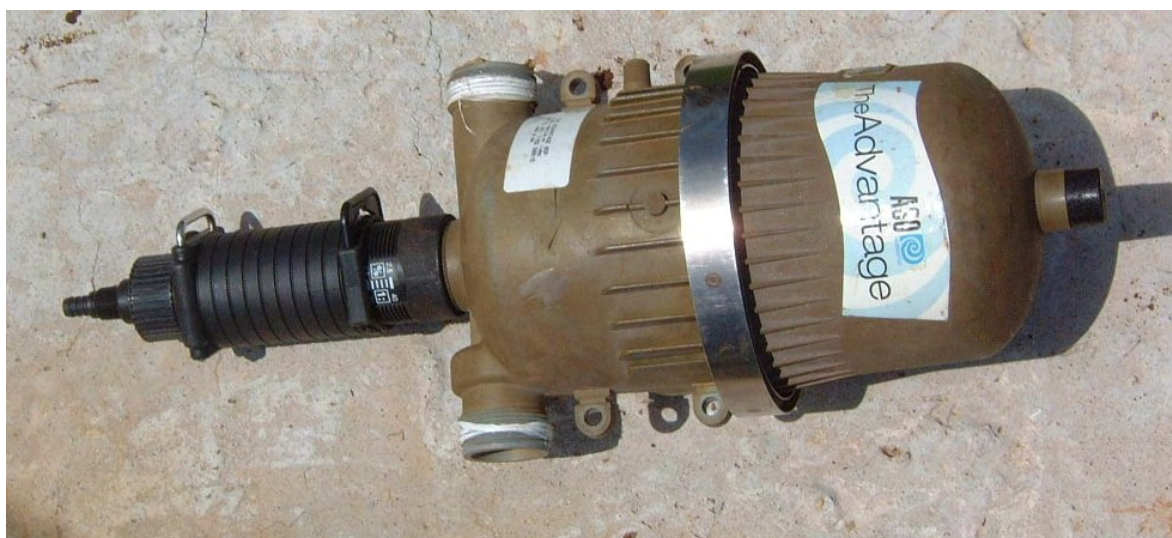
Figura 5 Bomba dosadora hidráulica proporcional Dosmatic Advantage A 30 utilizada no experimento
