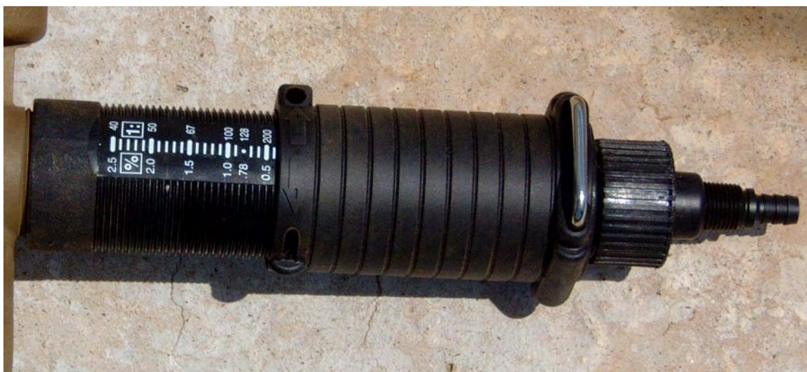
Figura 6 Detalhamento do cilindro dosador da bomba injetora hidráulica proporcional Dosmatic Advantage A 30
