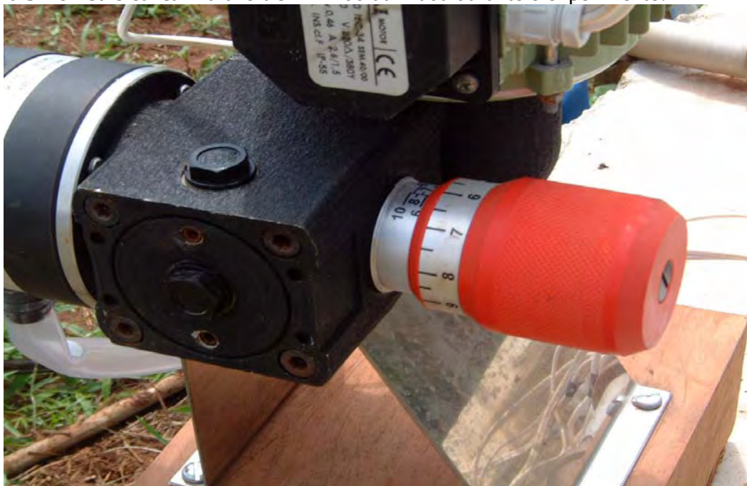
Figura 4 Detalhamento do regulador de taxa de injeção da bomba Multifertic MF –100
