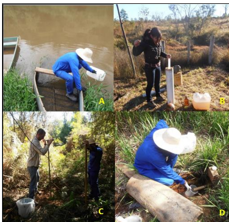
Figura 13 – Amostragem de água fluvial (A), água subterrânea (B), solo (C) e efluente gerado nas pilhas de rejeito da mina (D).
