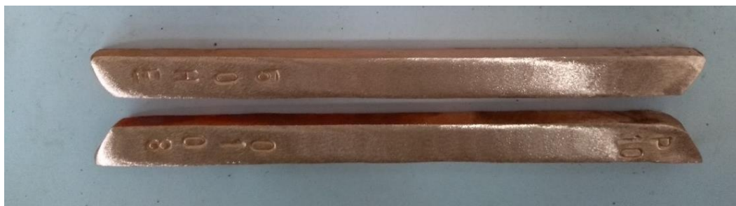
Fotografia 05 – Corpo de prova para ensaio de dobramento lateral.
