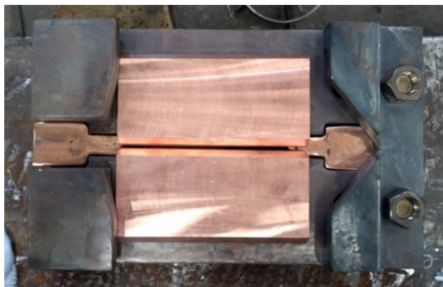
Fotografia 01 – Chapas no dispositivo de soldagem
