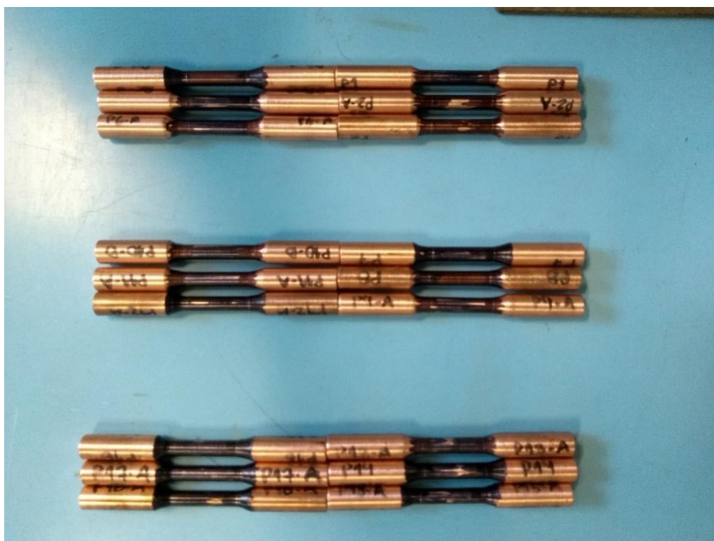
Fotografia 04 – Conjunto de CDP's preparados para ensaio de tração
