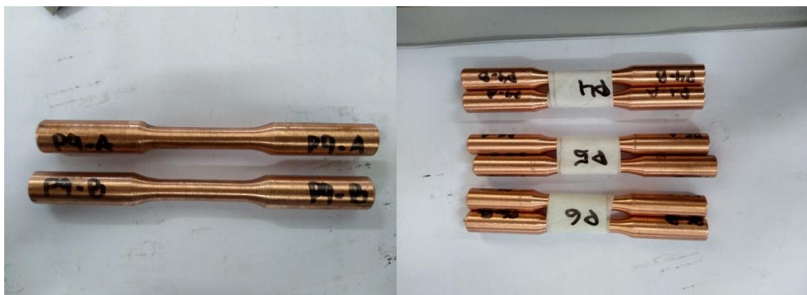
Fotografia 03 – Identificação dos corpos de prova para ensaio de tração.
