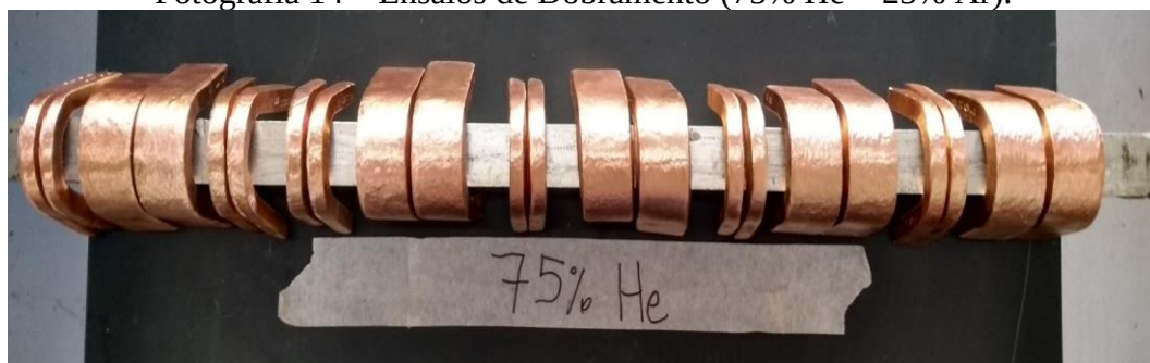
Fotografia 14 – Ensaios de Dobramento (75% He + 25% Ar).
