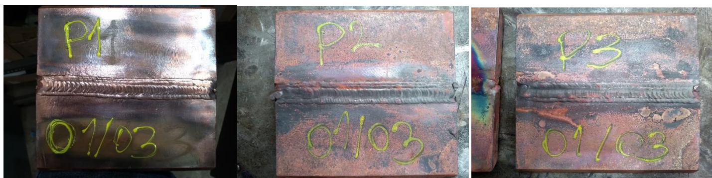
Fotografia 09 – Chapas pós-soldadas para ensaio visual.
