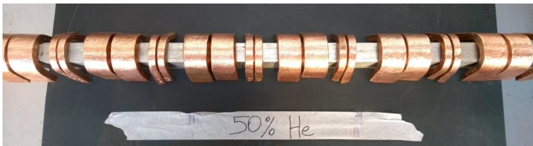
Fotografia 15 – Ensaios de Dobramento (50% He + 50% Ar).
