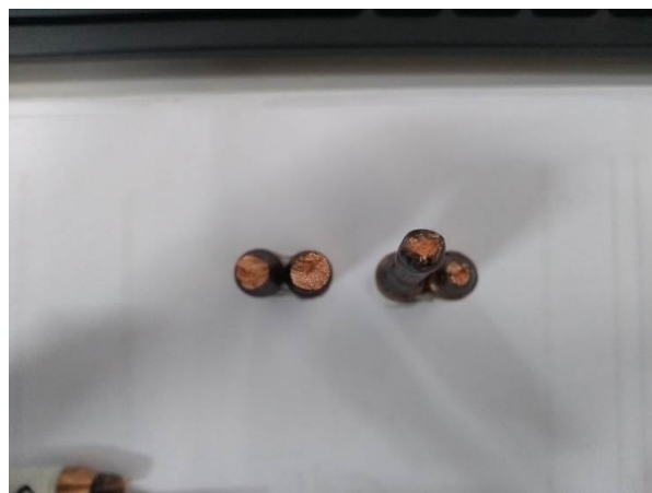
Fotografia 11 – Fratura: na solda / no metal base
