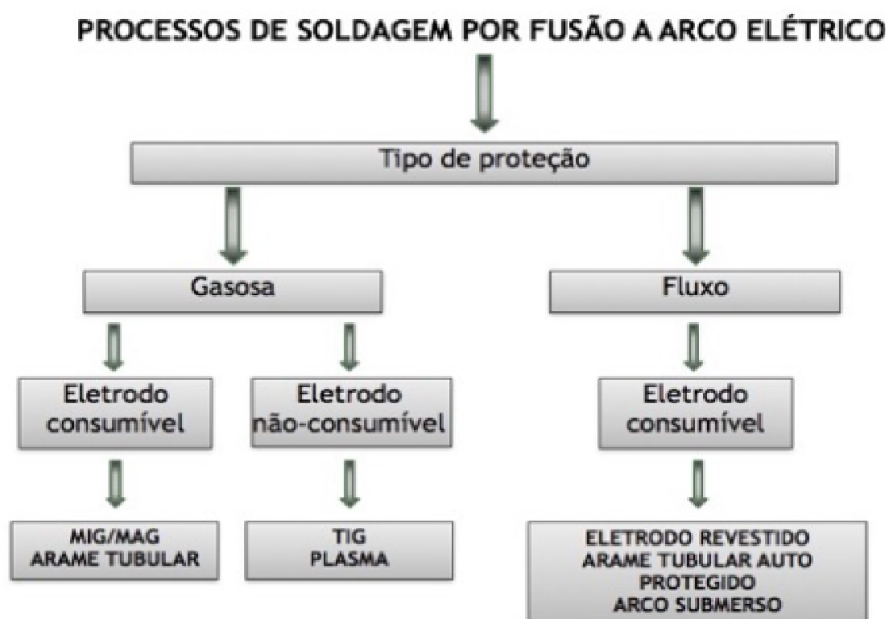
Figura 01 – Fluxograma dos tipos de proteção na soldagem.
