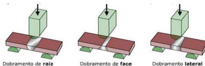
Figura 07 – Esquema de ensaio para dobramento transversal lateral, de face e de raiz.
