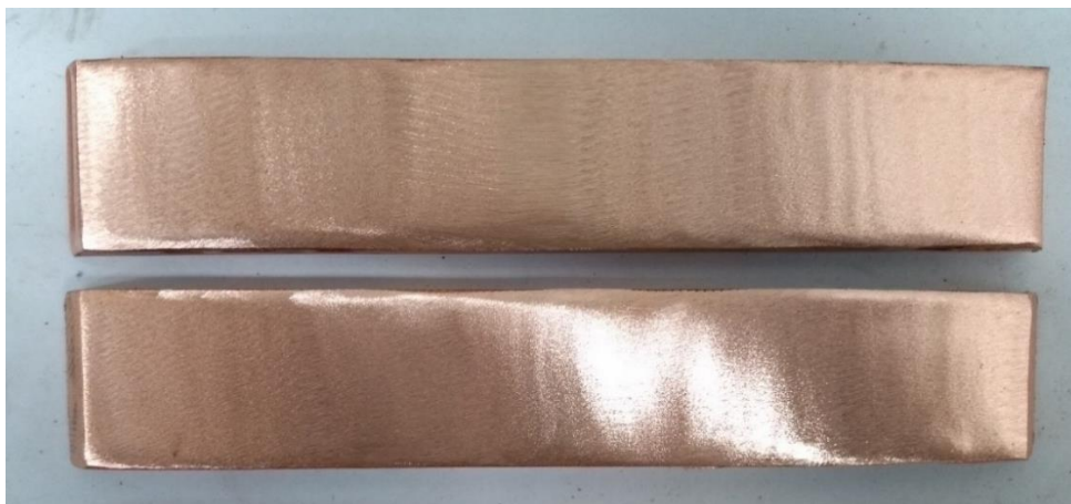
Fotografia 07 – Corpo de prova para ensaio de dobramento de face e de raiz.
