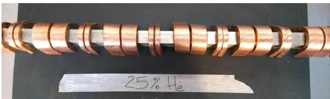
Fotografia 16 – Ensaios de Dobramento (25% He + 75% Ar).
