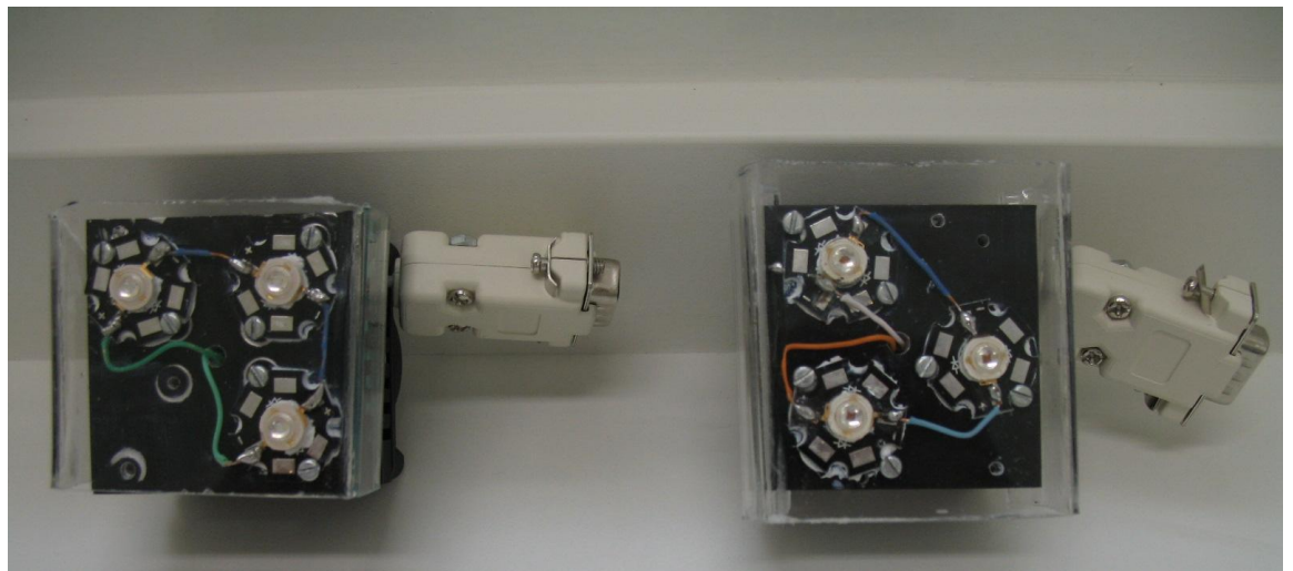
Figura 3: Jogo de LEDs azul e vermelho montados.
