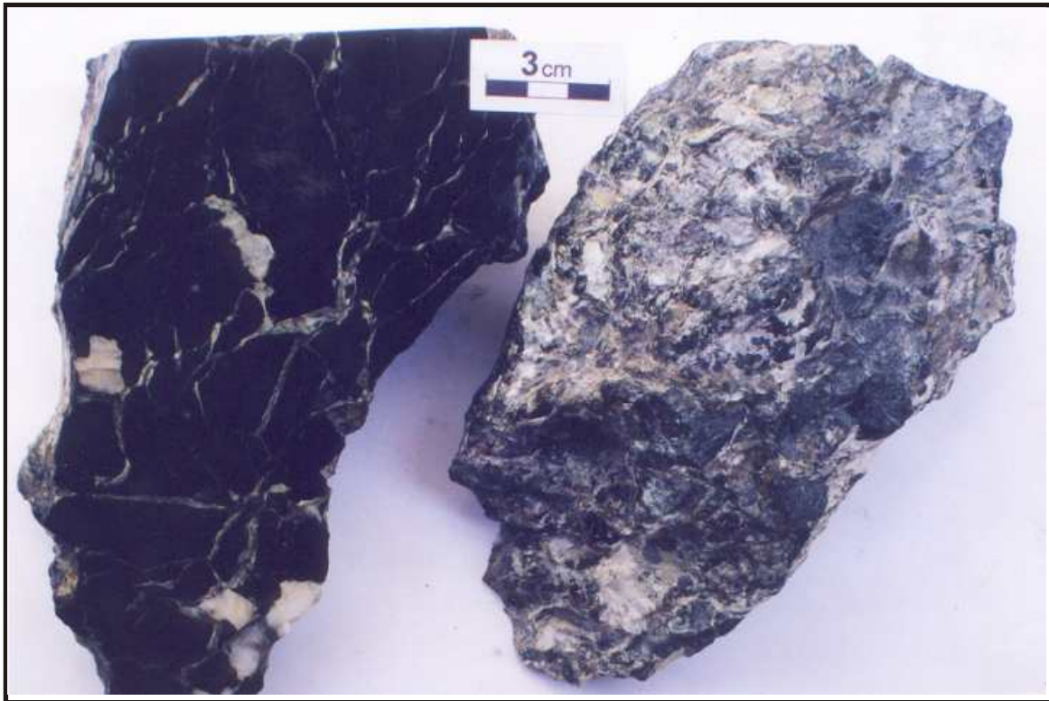
Figura 7 - Serpentinito encaixante do minério maciço hidrotermal exibindo fraturas preenchidas por carbonatos. Nas posições axiais (centro) dessas fraturas preenchidas por massas carbonáticas ocorrem finos veios sulfetados.
