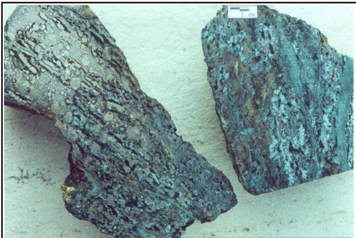
Figura 8 - Minério maciço hidrotermal formado por substituição intensa de talco-xisto. Pode ser observado ainda restos preservados do talco-xisto hospedeiro.
