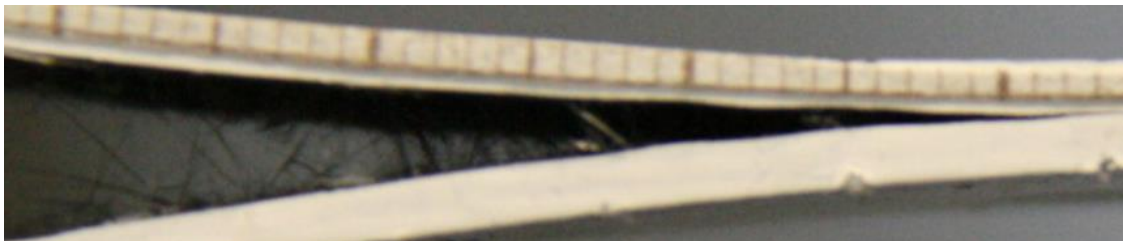
Figura 6 – Ocorrência de fiber bridging durante o ensaio de tenacidade à fratura numa amostra do tipo DCB.
