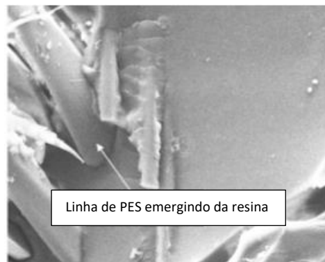
Figura 8 - Linha de PES emergindo da resina sem que a mesma esteja acumulada em sua superfície.
