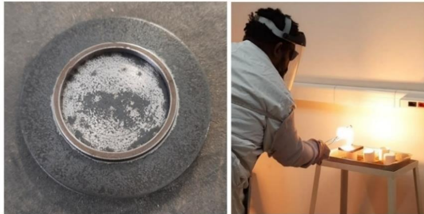
Figura 20 - Na (a), observa-se a placa metálica empregada na formação de bolacha vítrea; (b) Registro fotográfico que documenta o momento em que a amostra é despejada na placa metálica.
