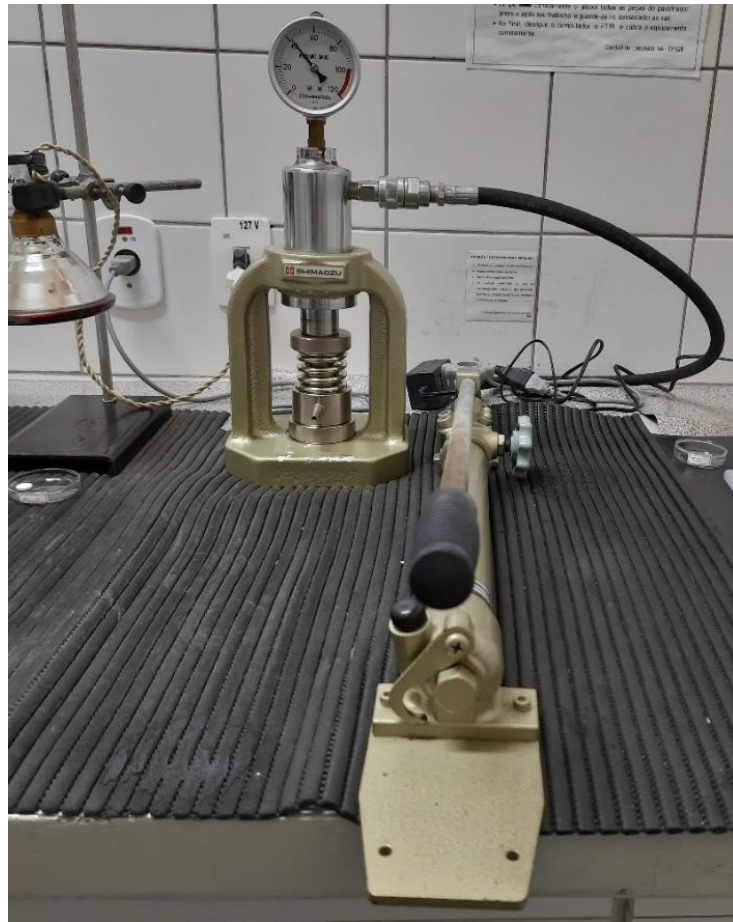
Figura 24 - Configuração visual da parte externa do equipamento prensa uniaxial Shimadzu.
