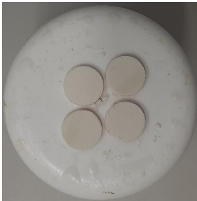
Figura 26 - Pastilhas de pó de vidro após passarem por tratamento térmico de 930 °C por 1 hora.
