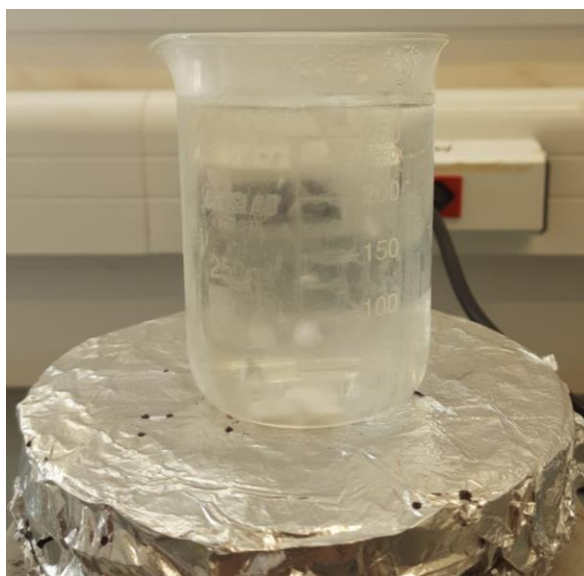
Figura 30 - Pastilhas vitrocerâmicas imersas em água disposta em um béquer sob chapa de aquecimento.
