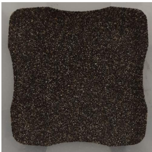
Figura 13 - Areia descartada de indústria de fundição (ADF), após passar por processo de peneiração, com intervalo granulométrico de 0,074 à 0,5mm.
