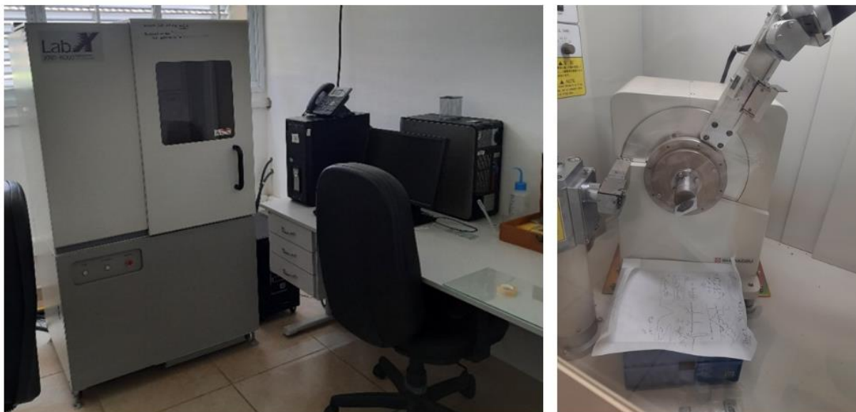
Figura 27 - (a) Exterior do difratômetro de raios X, modelo XRD6000 da Shimadzu, com a bancada de trabalho situada à direita da imagem; (b) Interior do difratômetro de raios X, incluindo o porta amostra e o detector móvel.
