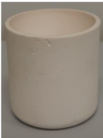
Figura 16 - Cadinho de alumina, com 5 cm de diâmetro por 10 cm de altura, para fusão em forno elétrico.
