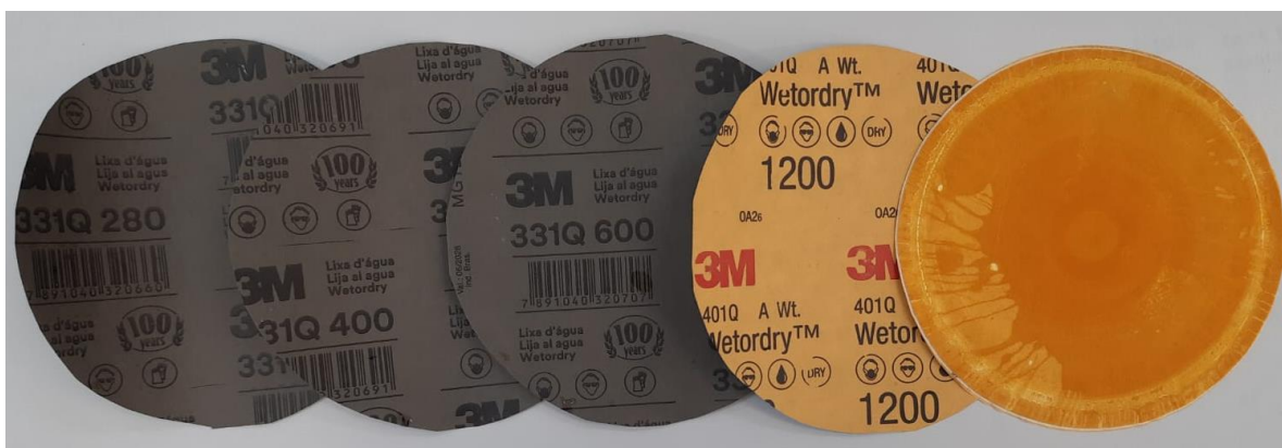
Figura 33 - Lixas d'água de diferentes granulações (280, 400, 600 e 1200) acompanhadas por uma esponja do tipo espuma.
