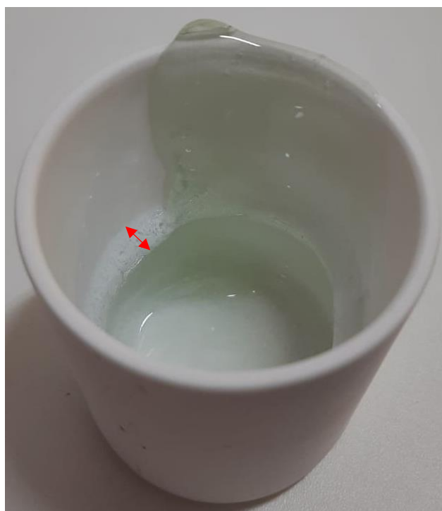
Figura 37 - Registro fotográfico do cadinho de alumina após processo de fabricação do vidro, com a presença do vidro residual e corrosão do cadinho.
