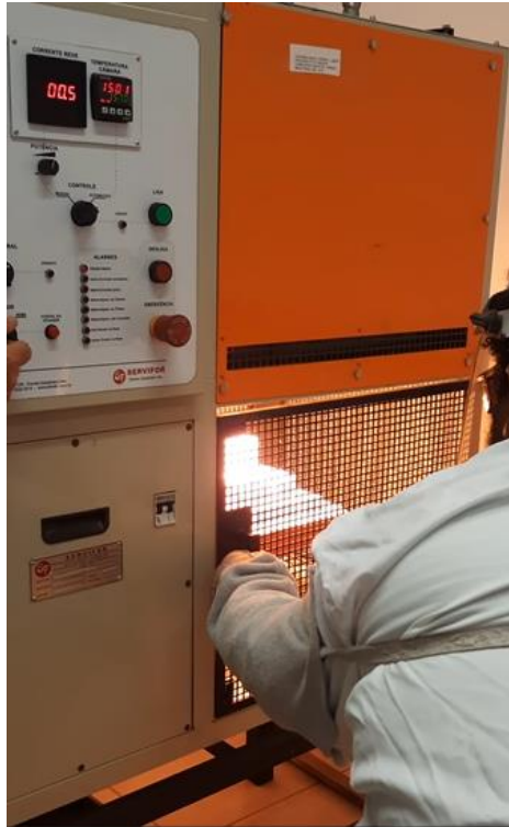
Figura 18 - Registro fotográfico do momento de retirada da amostra do forno.
