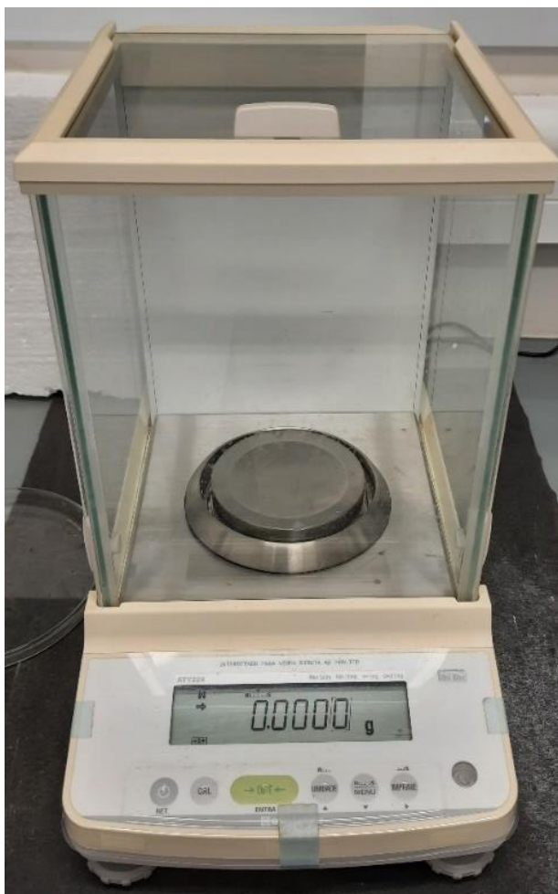
Figura 15 - Balança analítica com precisão de 0,1 mg.
