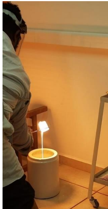
Figura 19 - Registro fotográfico do momento em que a amostra foi vertida em recipiente contendo água destilada à temperatura ambiente.
