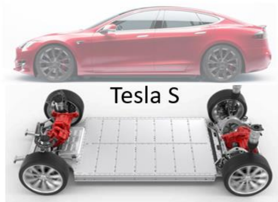
Figura 3 - Modelo Tesla S e sua base veicular com baterias integradas.
