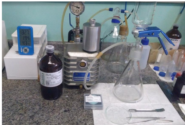
Figura 27 – Sistema de filtração a vácuo para a obtenção da membrana circular.
