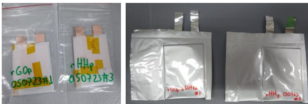
Figura 42 – Pouch-cell manufaturada antes (à esquerda), e após (à direita) encapsulamento em formato final de Pouch-Cell .
