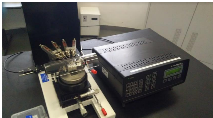
Figura 31 - Equipamento de medição de resistividade superficial de filmes por método de probe de quatro pontas (LPP-ITA).
