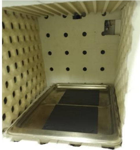
Figura 30 – Processo de tratamento térmico sútil em GOp em atmosfera de argônio.
