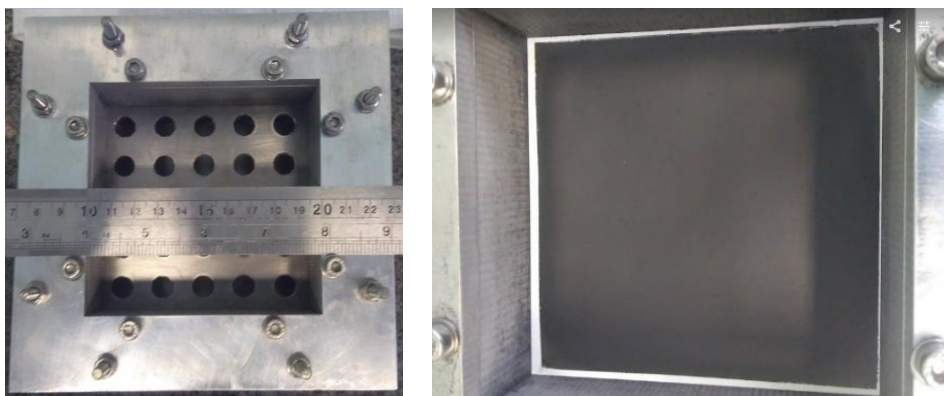
Figura 29 – Dispositivo metálico com dimensões de 100 mm x 100 mm utilizado na manufatura das membranas de maior dimensão, projetado por Santos e colaboradores (SANTOS, 2021) (à esquerda) e GOp aderido ao filtro de poliamida após processo de filtração (à esquerda).
