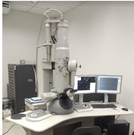
Figura 32 – Microscópio eletrônico de transmissão (120 kV) utilizado no IEAMAR.
