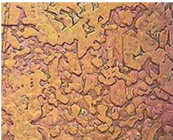
Figura 54 – Imagem de microscopia óptica com objetiva de 50X do filme polimérico de \text{Ni}_2(\text{Bisalphen}) obtido por eletropolimerização de 1,0 \text{ mmol L}^{-1} do complexo em THF/0,1 PTBA com 15 ciclos de potenciais a 50 \text{ mV s}^{-1} sobre substrato condutor de platina (microscópio óptico Leica modelo DMRX).
