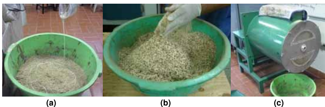
Figura 5 – Adição e homogeneização do adesivo.
