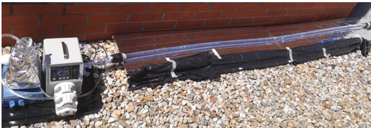
Figura 3.2: Reator em fluxo sob radiação solar. Retirado de Silva et al. (2024).
