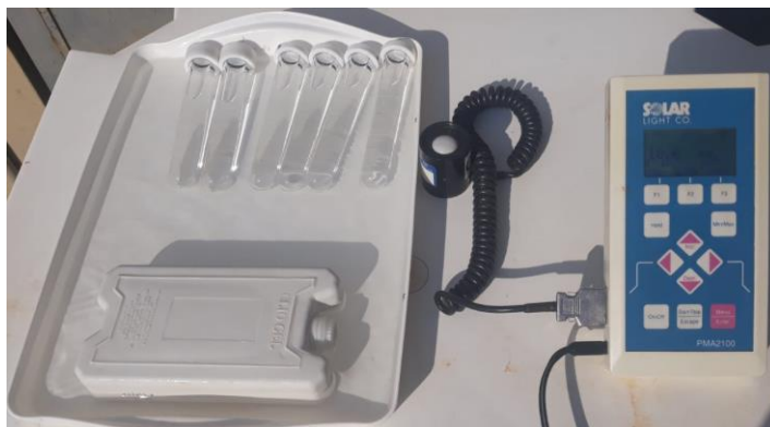
Figura 2: Sistema para estudo de fotólise solar.
