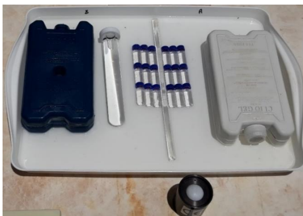
Figura 1.3: Sistema de exposição dos vials contendo solução dos antibióticos SMX e TMP ( 500 \mu\text{g L}^{-1} ) em água e efluente durante experimento de fotólise solar.
