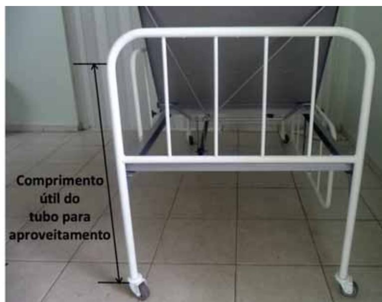
Figura 17 – Reaproveitamento dos tubos de aço
