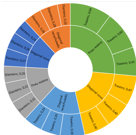
Figura 22. Área de contato ( m^2 ) dos pneus dianteiros e traseiros para os três tipos de pneus avaliados.
