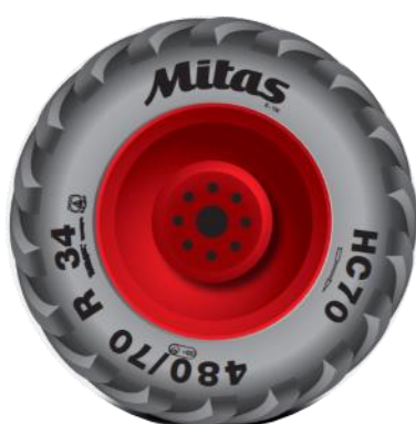
Figura 6. Informações técnicas estampadas nas laterais dos pneus, Fonte: Mitas (2023).
