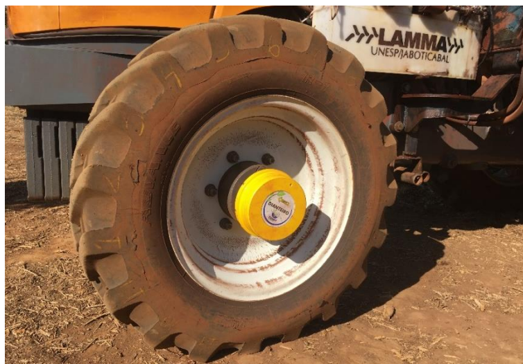
Figura 15. Avançômetro localizado na roda dianteira esquerda do trator. Fonte: Autor (2022).
