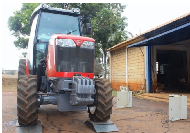
Figura 20. Aferição da massa do trator quando equipado com os pneus-esteira. Fonte: Autor (2023).
