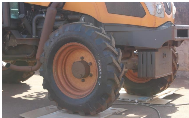
Figura 14. Aferição da massa do eixo dianteiro do trator equipado com pneus diagonais. Fonte: Autor (2022).
