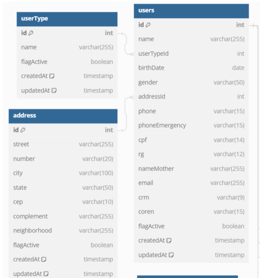
Figura 10 - Parte de Usuários presente no modelo do banco de dados construído no dbdiagram.io
