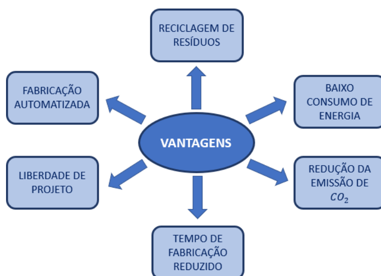
Figura 16 - Fluxograma indicando as vantagens da tecnologia de impressão 3D utilizando geopolímeros.
