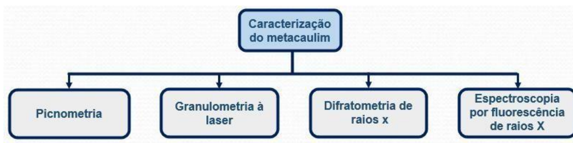
Figura 18 – Fluxograma das técnicas utilizadas para a caracterização do metacaulim.
