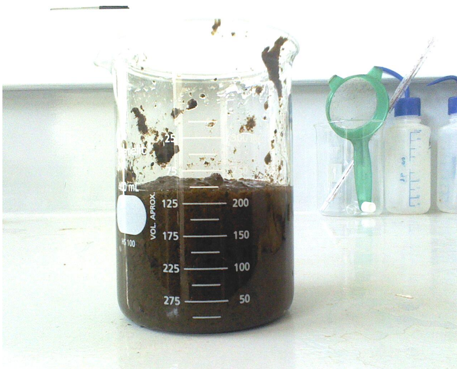
Figura 8 – Fotografia do lodo usado como inóculo do reator.
