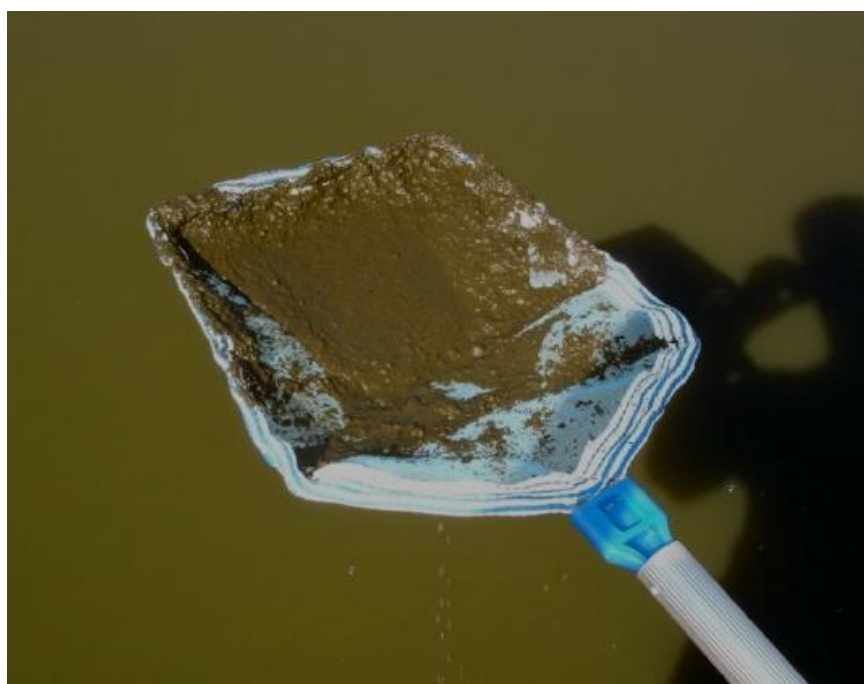
Figura 9 – Fotografia da coleta do lodo flotado sobre a superfície da lagoa anaeróbia.
