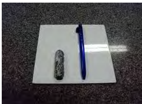
Figura 27 – Lingote das ligas Ni-Cr-Mo e Ni-Cr-Nb após fusão a arco.
