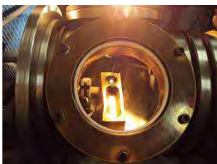
Figura 25 – Cadinho durante processo de fusão utilizado neste trabalho.
