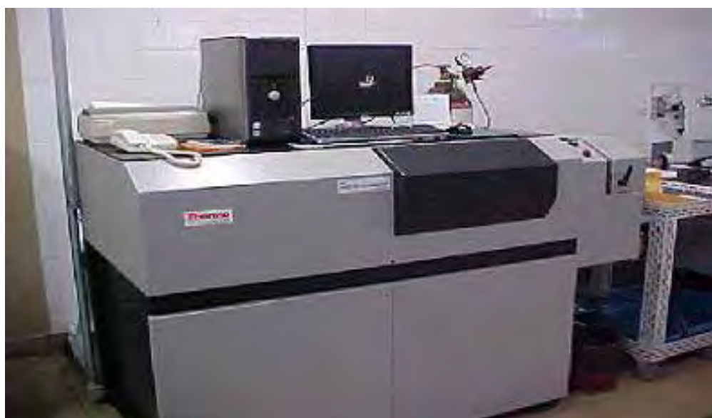
Figura 35 – Espectrômico ARL 3460 instalada na TENARIS/CONFAB.
