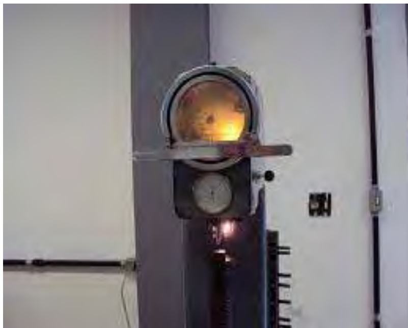
Figura 34 – Durômetro no momento da leitura.
