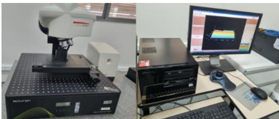
Figura 20- Microscópio confocal para aquisição de imagens topográficas da superfície
