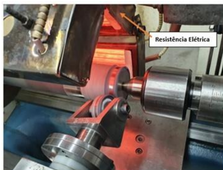
Figura 15 - Roleteamento aquecido com resistência elétrica
