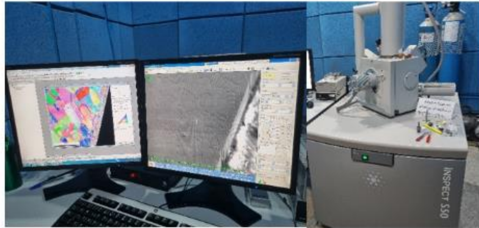
Figura 22 - Microscópio eletrônico de varredura com acessório para análise de orientação cristalográfica
