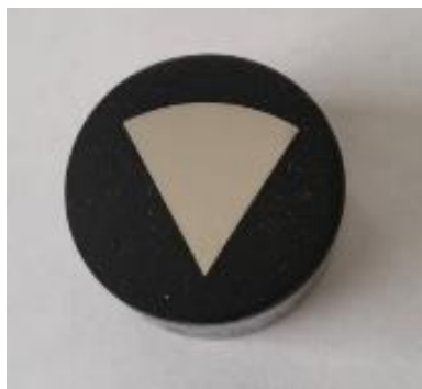
Figura 17 - Corpo de prova embutido para as análises
