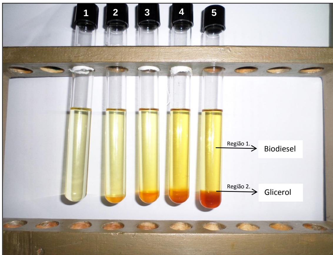
Figura 15: (1) Óleo de soja comercial e frações denominada biodiesel obtidas na presença de (2) \text{SrTiO}_3 , (3) \text{Sr}_{0,8}\text{K}_{0,2}\text{TiCu}_{0,10}\text{O}_3 , (4) \text{Sr}_{0,7}\text{K}_{0,3}\text{TiCu}_{0,15}\text{O}_3 e (5) \text{Sr}_{0,5}\text{K}_{0,5}\text{TiCu}_{0,25}\text{O}_3 como catalisadores, respectivamente, com tempo reacional de 8 horas e massa do catalisador de 5% em relação ao óleo de soja.
