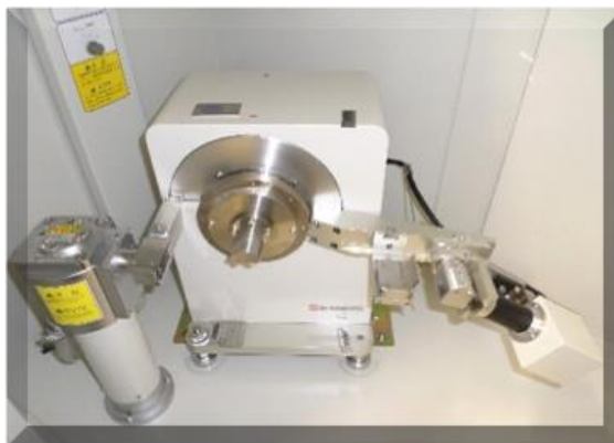
Figura 11: Equipamento SHIMADZU (modelo XRD-6000) utilizado para acompanhar a evolução da cristalinidade por difração de raios X.
