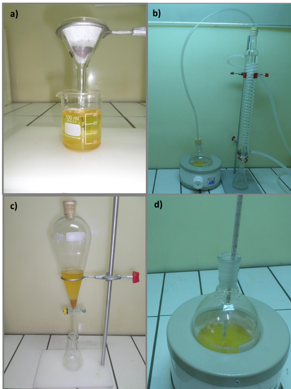
Figura 17: Etapa (a) filtração, (b) evaporação (c) decantação e (d) secagem.
