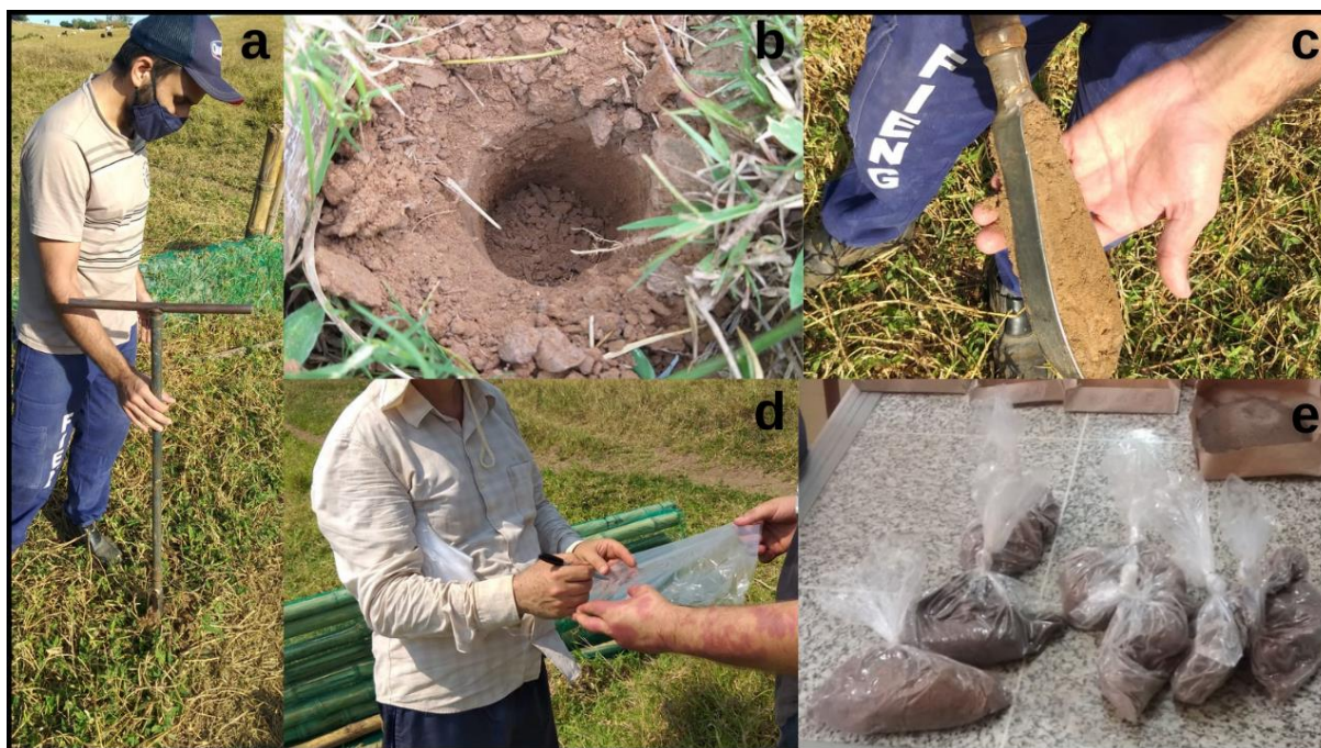
Figura 13 - Coleta amostras de solo com o uso do trado do tipo Holandês.
