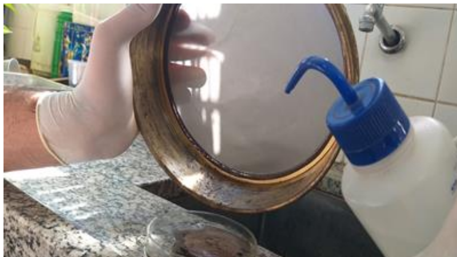
Figura 19 - Adicionando material retido na peneira em uma Placa de Petri
