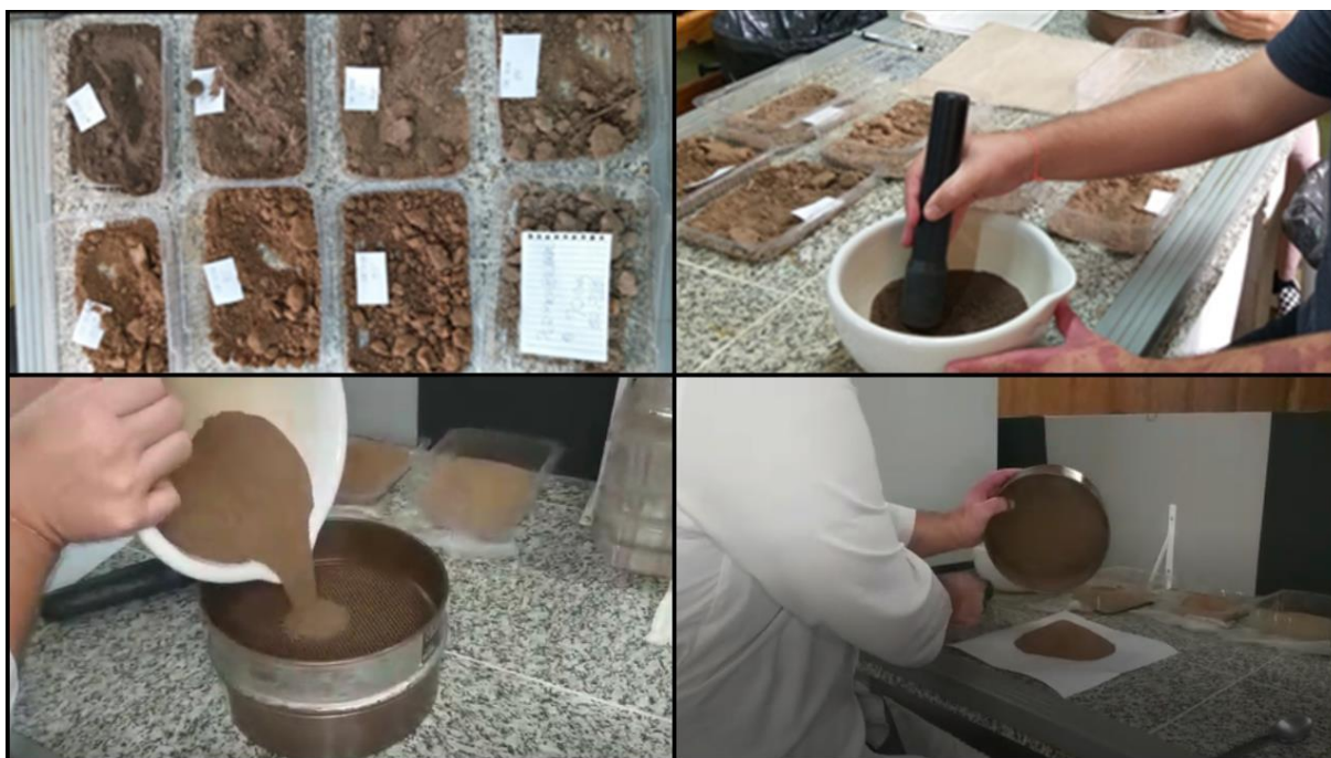
Figura 14 - Secagem das amostras, destorroamento e peneiramento
