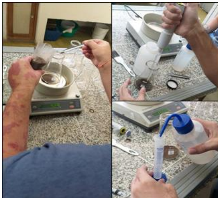
Figura 16 - Pesagem das frações das amostras, adição da água deionizada e da solução de hidróxido de sódio (NaOH)
