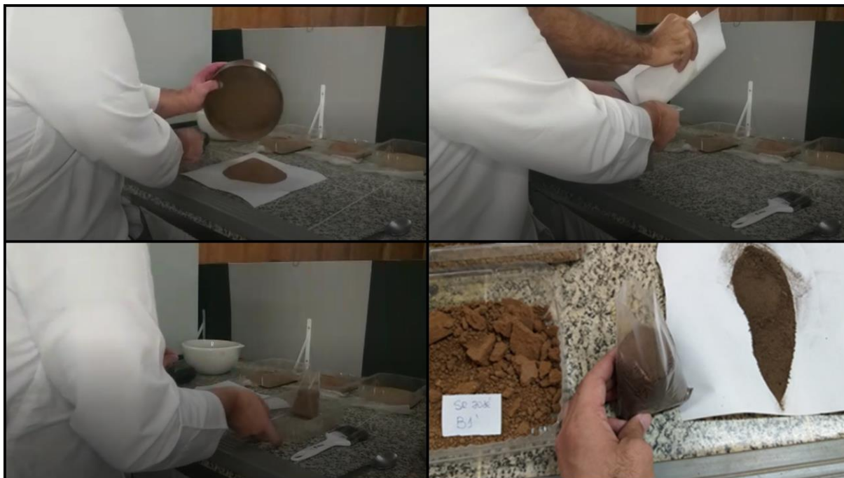
Figura 15 - Amostra sendo reservada após destorroamento e peneiramento
