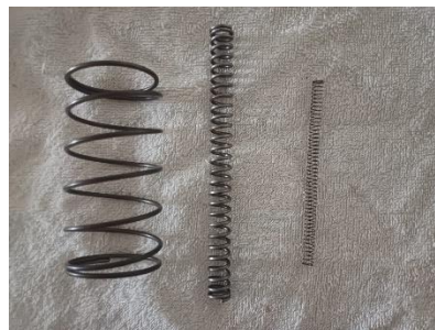
Figura 56- Molas adquiridas, da esquerda para a direita: 2666 (32702,18N), 2692 (14460,47 N), 402 (721,865 N)
