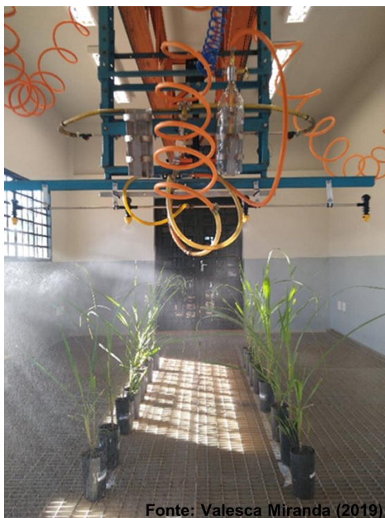
Figura 2 – Aplicação dos tratamentos em pulverizador estacionário
