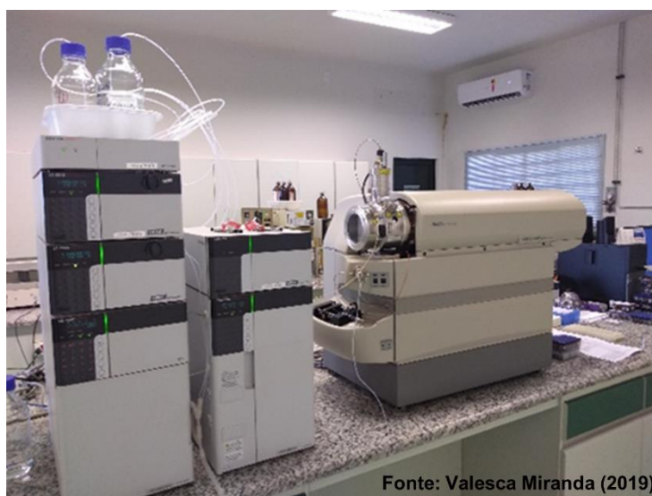
Figura 5 – Cromatógrafo líquido (Prominence UFLC) acoplado ao espectrômetro de massas (Triple Quad 3200, AB Sciex)
