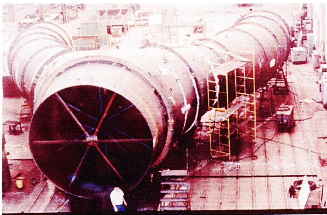
Figura 4.3 – Bifurcação em fase de pré - montagem na fábrica
