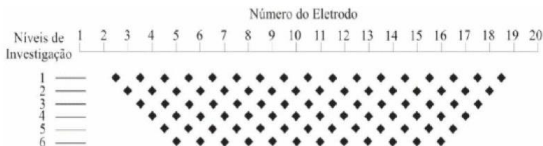
Figura 18. Esquema de plotagem dos pontos dos níveis de investigação em uma pseudo-seção de resistividades aparentes (LAUREANO, 2007).
