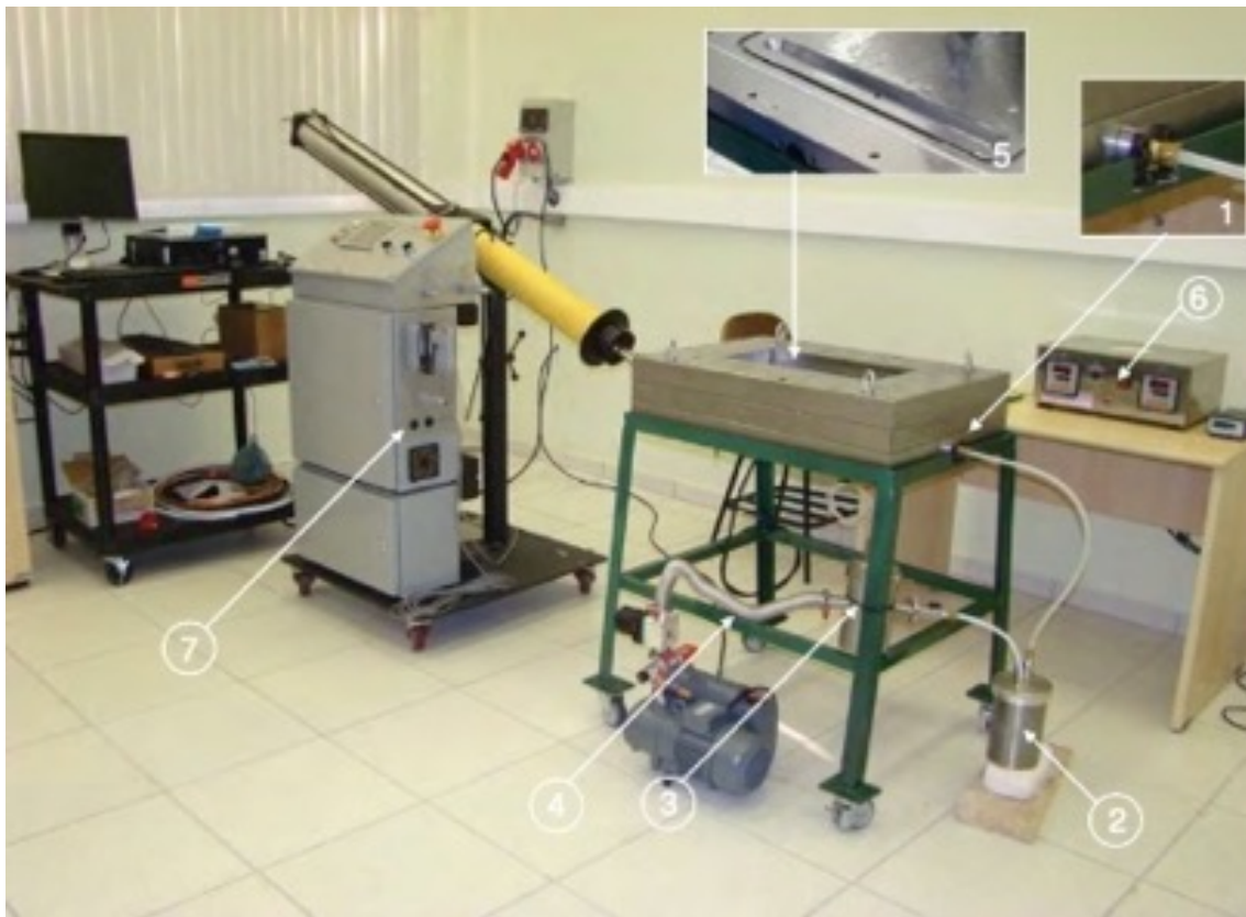
Figura 16 - Equipamento RTM utilizado para processar o compósito.
