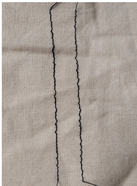
71. Teste de tensão de linha quatro aplicada ao algodão cru
