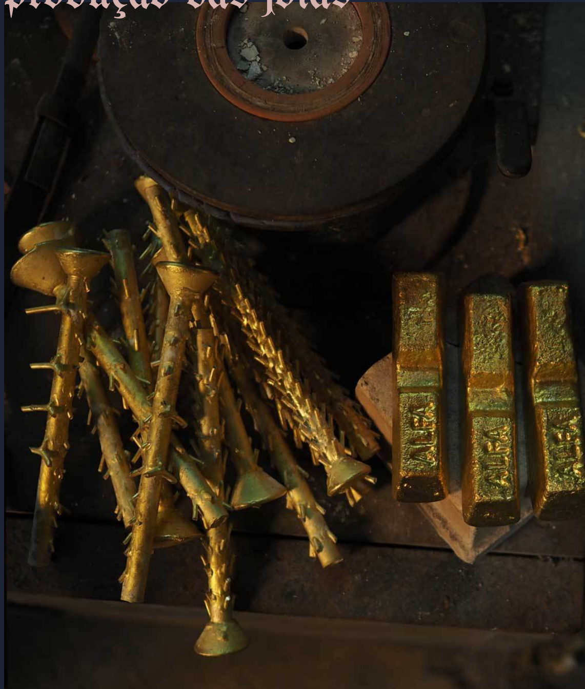
82. Resto das árvores depois da fundição e barras de latão
