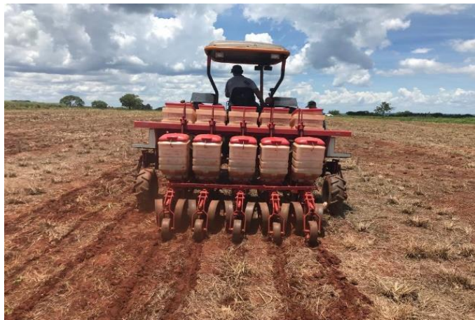
Figura 7. Semeadora e adubadora de fluxo contínuo utilizada no experimento.
