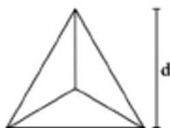
Figura 6 - Impressão residual deixada pelos penetradores: (a) a ponta Berkovich de base triangular usada no teste.
