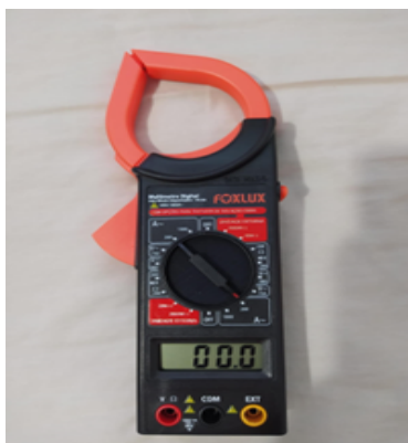
Figura 3 – Equipamento utilizado para aferição da corrente.
