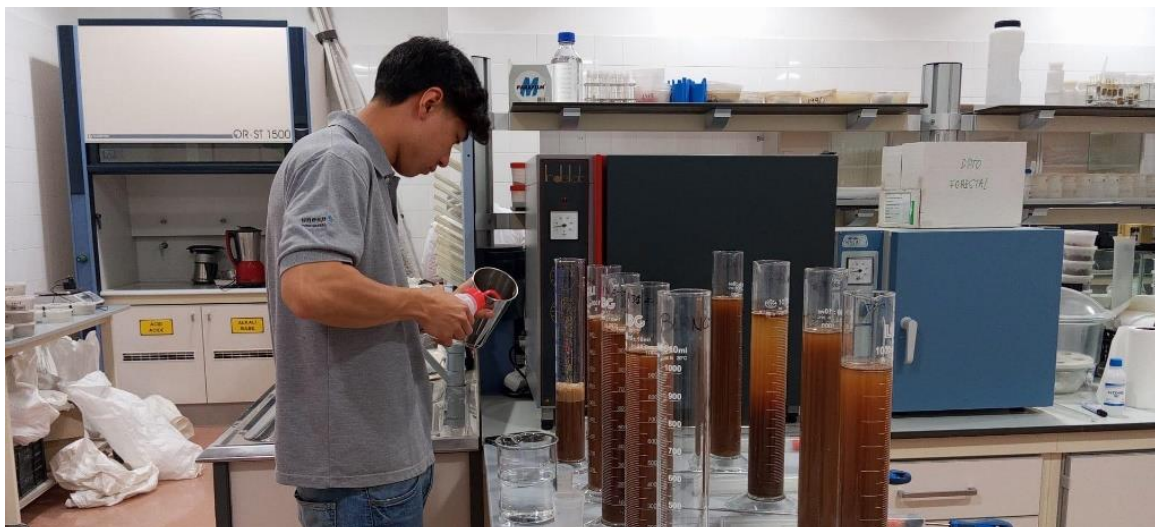
Figura 5. Transferência da suspensão para proveta graduada de 1 L e início da sedimentação ( t = 0 ) na análise granulométrica. Fonte: Acervo pessoal do autor (2025).
