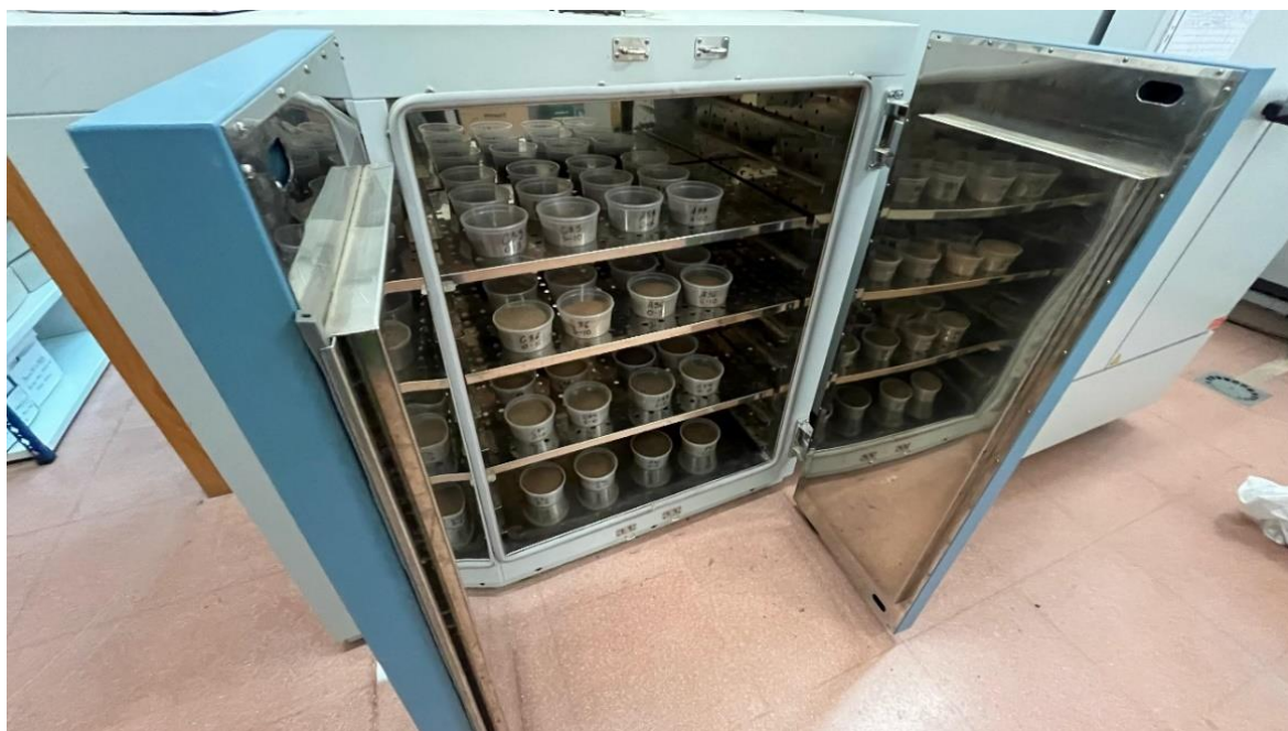
Figura 3. Secagem das amostras de solo em estufa a 105 °C. Fonte: Acervo pessoal do autor (2025).
