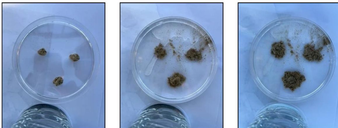
Figura 10. Registro visual do experimento com o aplicativo SLAKES para avaliação da estabilidade de agregados do solo. A imagem da esquerda representa o início do experimento ( t = 0 min), com os agregados ainda íntegros. A imagem central mostra o estado dos agregados após 5 minutos, com início de desagregação. A imagem da direita apresenta os agregados ao final do experimento ( t = 10 min), evidenciando o grau de desagregação em água deionizada. Fonte: Acervo pessoal do autor (2025).
