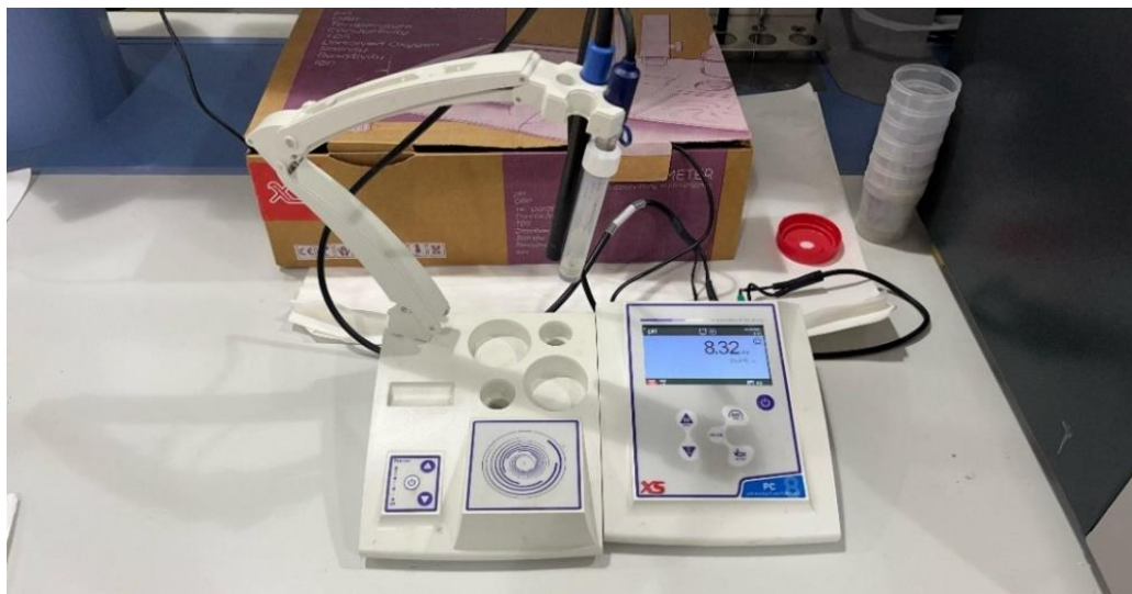
Figura 7. Medidor de bancada XS Instruments modelo PC 7, equipado com eletrodo de vidro e suporte articulado, utilizado para determinações de pH do solo. Fonte: Acervo pessoal do autor (2025).
