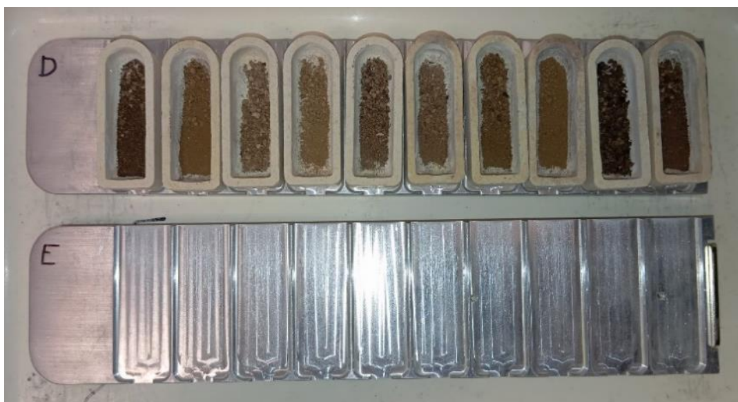
Figura 6. Amostras de solo após preparo para determinação de carbono orgânico total. Fonte: Acervo pessoal do autor (2025).
