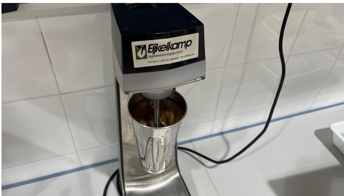
Figura 4. Agitação da suspensão solo dispersante em agitador mecânico (5 min, 10 000 rpm) para análise granulométrica pelo método de Bouyoucos. Fonte: Acervo pessoal do autor (2025).
