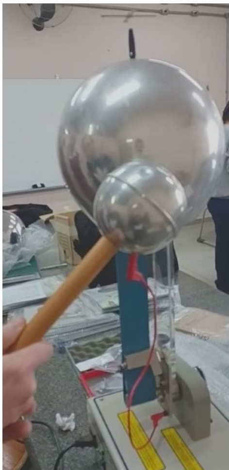
Figura 7: marcas de amassado na esfera utilizada. Fotos feitas pelos autores
