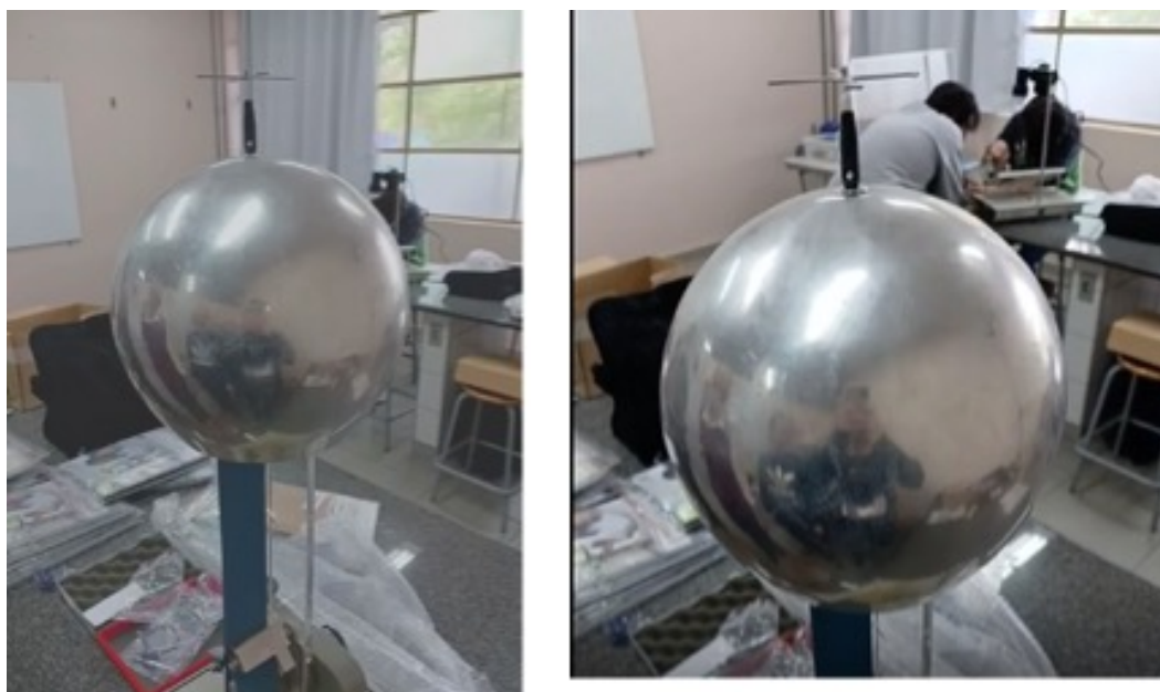
Figura 6: Visão do aparato experimental montado, o torniquete apoiado sob uma ponta, conectado a esfera condutora, o torniquete gira, ao ser eletricamente carregado. Fotos feitas pelos autores
