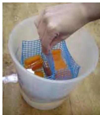
Figura 12: Amostras sendo lavadas em água destilada por 10 segundos.
