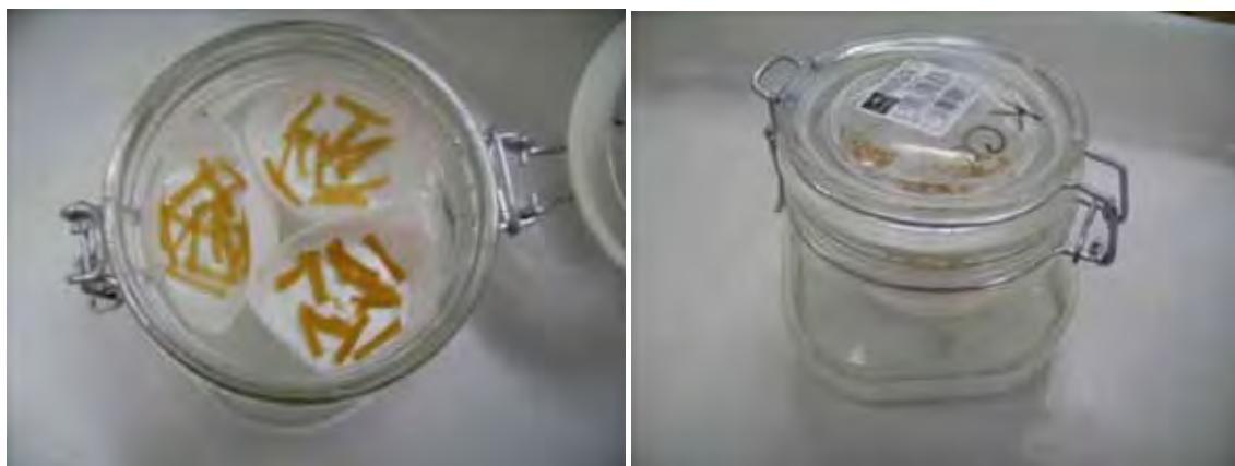
Figura 17: Amostras cortadas e acondicionadas em cápsulas de plástico e frasco utilizado para determinação das isotermas.
