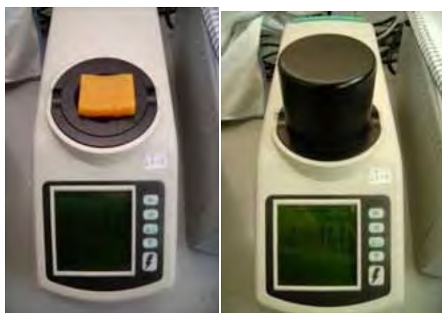
Figura 20. Espectrofotômetro ColorFlex com amostra e com o copo plástico.
