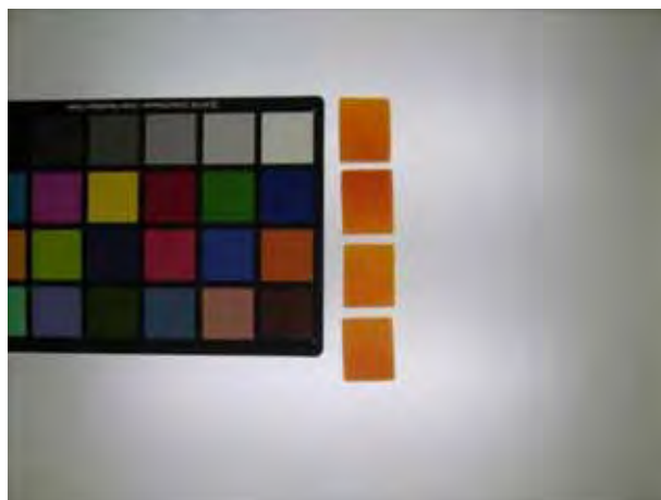
Figura 19: Padrão e amostras sendo fotografados para posterior análise de cor em software acadêmico.
