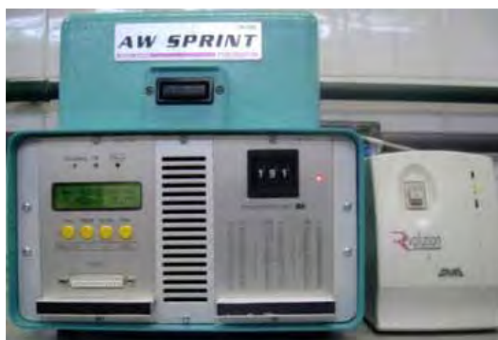
Figura 23: Equipamento da Novasina para análise da atividade de água.
