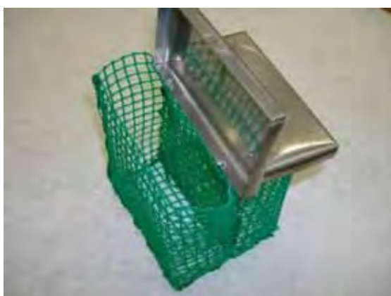
Figura 9: Cesto de nylon para comportar as amostras no banho osmótico.
