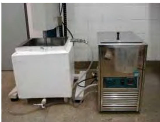
Figura 11: Equipamento de DO: cuba, banho ultratermostatizado e agitador mecânico.
