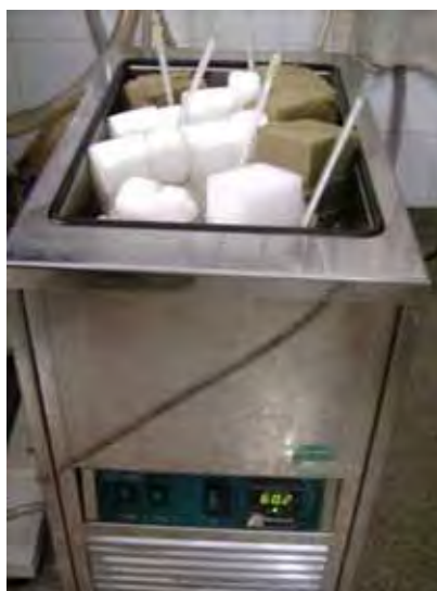
Figura 7: Banho ultratermostatizado com béqueres contendo amostras
