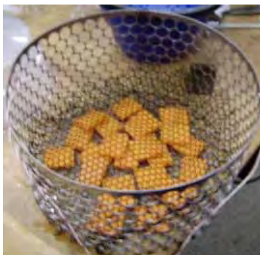
Figura 8: Cesto com tela usado no branqueamento a 97°C das amostras.
