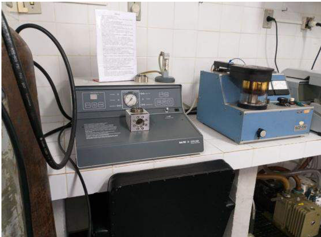
Equipamento Secador para desidratação das amostras através do ponto crítico (Bal-tec CPD 030) e metalização com ouro (Bal-tec SCD 030).
