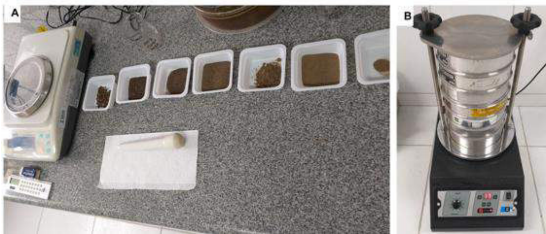
Figura 10. Análise de granulometria do sedimento do Rio Doce
