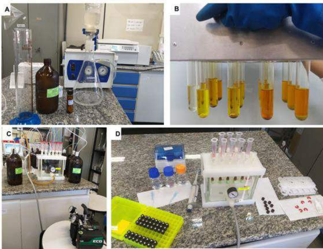
Figura 9. Procedimentos para a extração das amostras de água e sedimento para as análises químicas de metais e compostos orgânicos.
