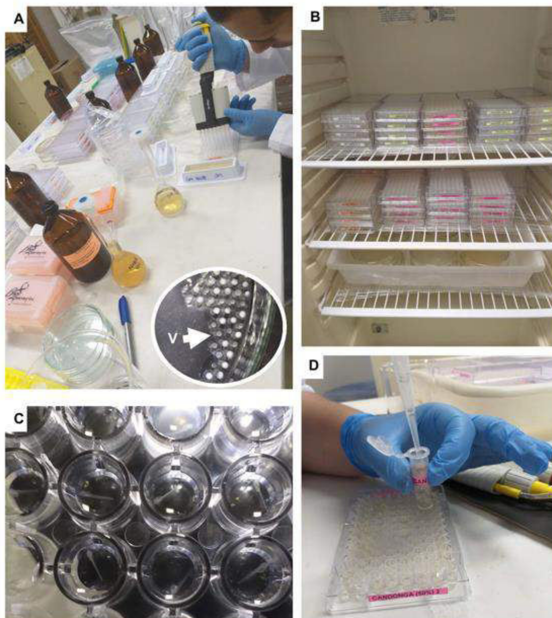
Figura 16. Procedimentos para o teste de toxicidade com os embriões de jundiá expostos por 96hpf
