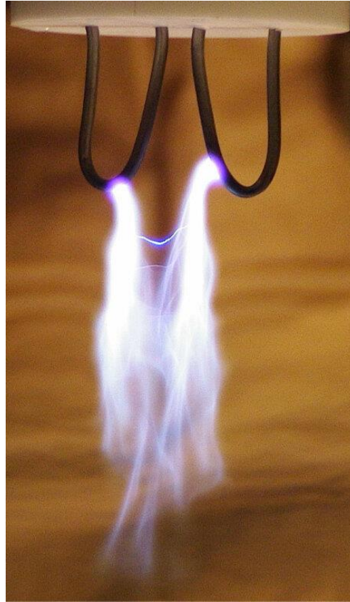
Figura 5 — Descarga em arco entre dois eletrodos
