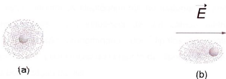
Figura 2.2.1.1 –(a) Ilustração esquemática de um átomo, na ausência de campo elétrico externo, ( \vec{E} = 0 ); (b) observa-se um dipolo induzido, pela presença de um campo elétrico externo.
