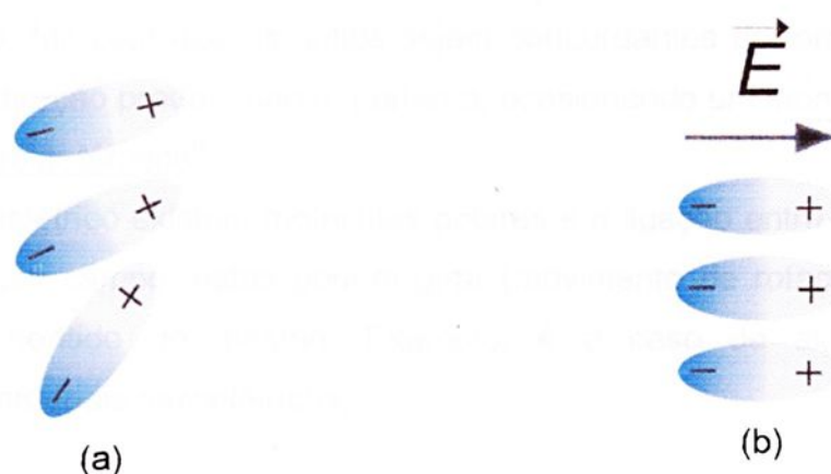
Figura 2.2.1.3 –(a) Representação esquemática de dipolos distribuídos aleatoriamente na ausência do campo elétrico, ( \vec{E} = 0 ); (b) Representação esquemática dos dipolos orientados após a aplicação do campo elétrico externo.
