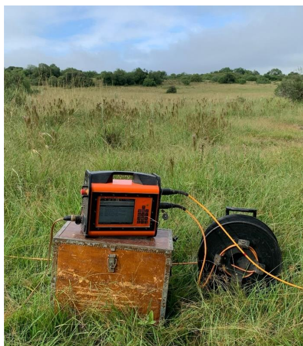
Figura 27 - Equipamento Terrameter LS (ABEM) utilizado no levantamento geofísico.
