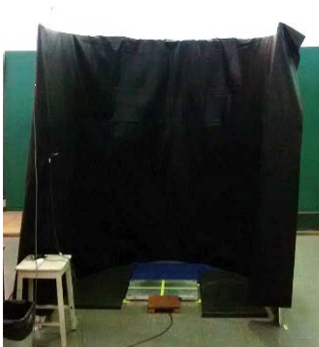
Figura 4: Foto do local e da estrutura utilizada para a realização dos procedimentos experimentais. A plataforma de força está posicionada ao chão, na região central.
