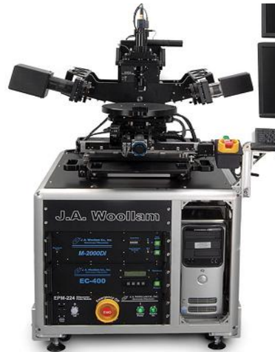
Figura 17 - Foto do espectro-elipsômetro M-2000 da empresa J.A. Woollan Corporation utilizado.
