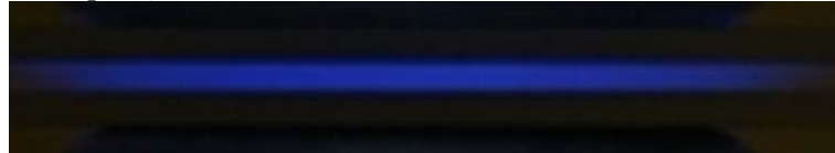
Figura 12. Modo de operação difuso DBD
