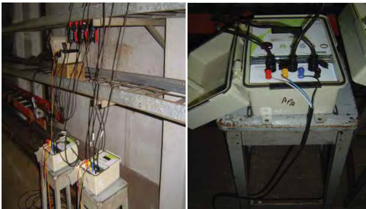
Figura 8. Analisador Saga 4500 utilizado para coleta de dados na usina USA
