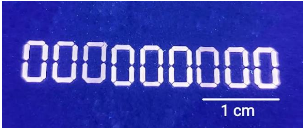
Figura 22: Resina polimerizada via laser em lâmina. Sequência de zeros simulando a representação de um display de calculadora.
