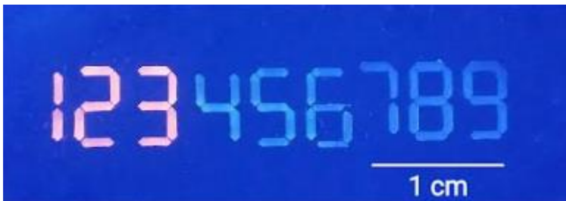
Figura 21: Resina polimerizada via laser em lâmina. Representação de um display de números.
