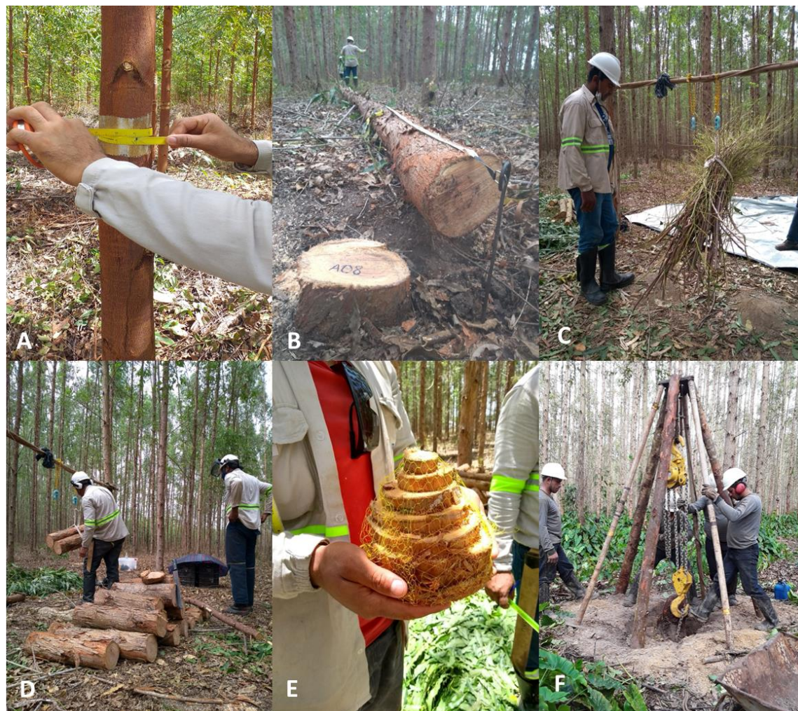
Figura 2 – Etapas de coleta de dados (A) Inventário florestal, (B) Cubagem rigorosa, (C) Biomassa aérea de pesagem de galho, (D) Biomassa aérea de pesagem de lenho, (E) Discos separados por seções e (F) Biomassa de raízes
