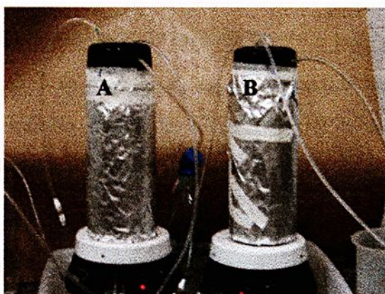
Figura 12. Montagem dos reatores (A- Reator sem agitação; B- Reator com agitação).
