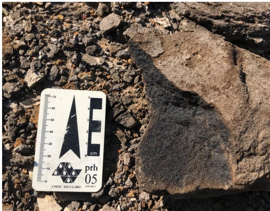
Figura 6 – Arenito saturado em asfalto. Amostra retirada de um afloramento da Formação Pirambóia localizado no Morro do Bofete.
